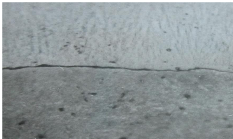
Рис. 3.13 Микроструктуры электролитического железа, полученного при плотностях тока 8 \dots 10 \text{ А / дм}^2
