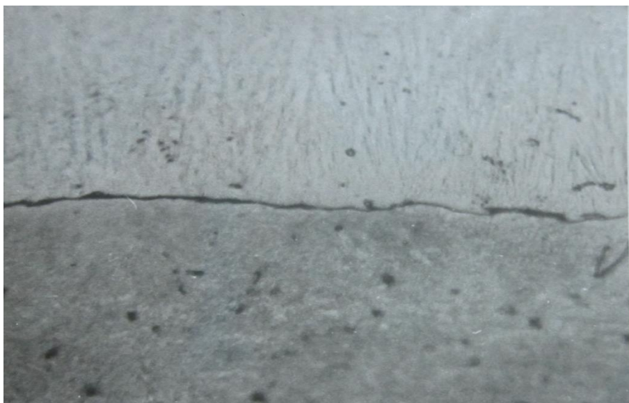
Рис. 3.3 Структура покрытия электролитического железа, полученного в проточном электролите
