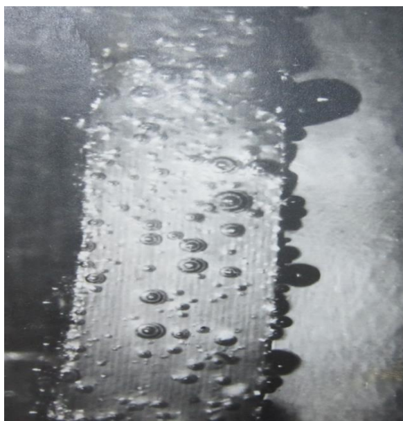
Рис. 3.24 Адсорбция водорода, выделяющегося при электролизе, на поверхности катода
