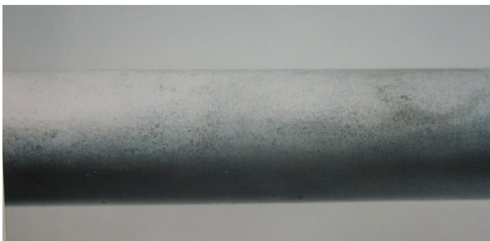
Рис. 3.27 Образец, полученный при железнении с созданием разрежения над зеркалом электролита
