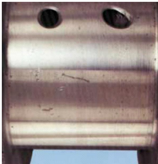
Рисунок 1.1-Трещины на шейке
