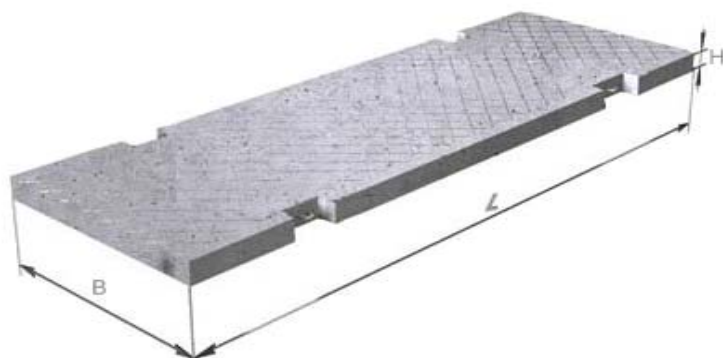
Рисунок 15 – Железобетонная плита ПАГ-14, где L - 6,0 B - 2,0 H - 0,14 м
