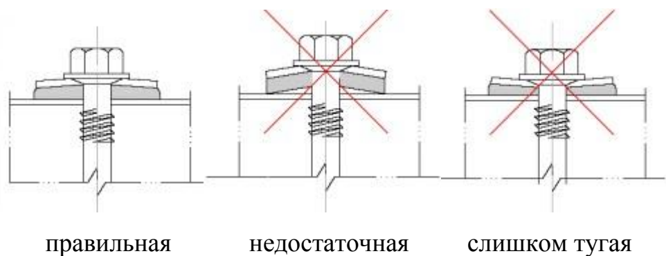
Рис.22. Посадка шурупов
