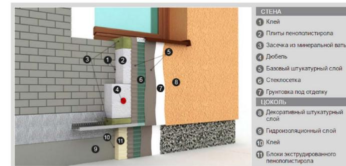
Рис.1. Конструктивная схема трехслойной стены
