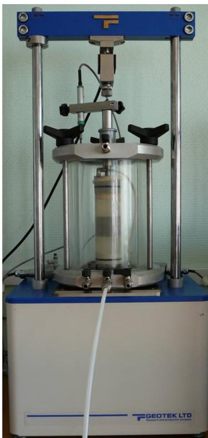
Рисунок 1.37 –Установка камеры трехосного сжатия на столик нагрузочной рамы
