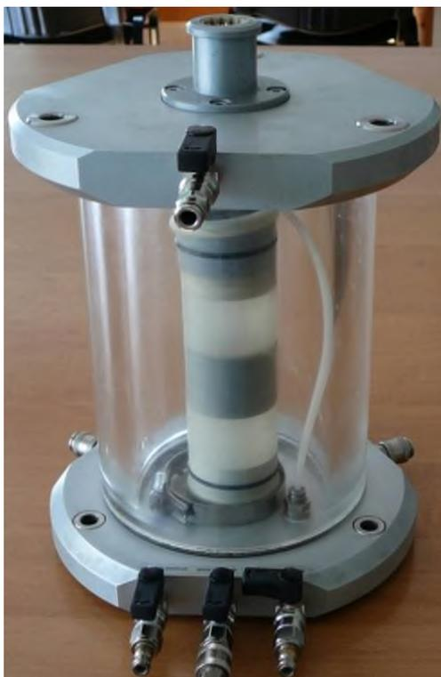
Рисунок 1.35 – Установка колбы и крышки камеры
