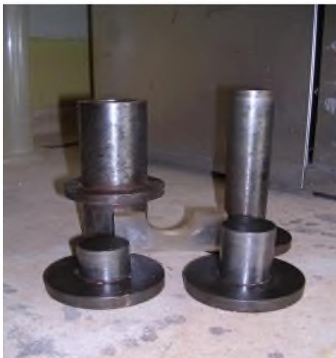
Рисунок 4.2 – Прессформа для подготовки образца грунта
