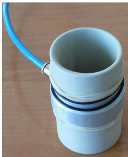
Рисунок 1.29 – Установка резиновой оболочки на расширитель
