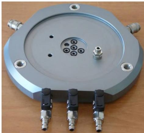
Рисунок 1.25 – Основание камеры трехосного сжатия
