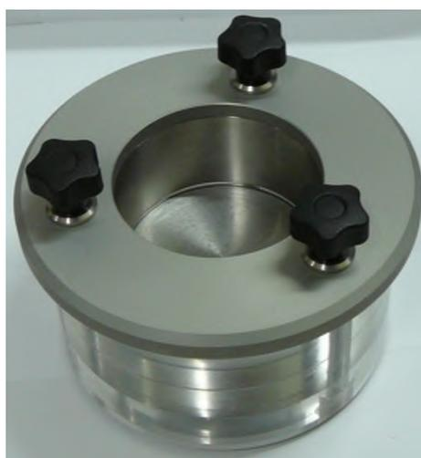
Рисунок 1.18 –Установка прижимного кольца
