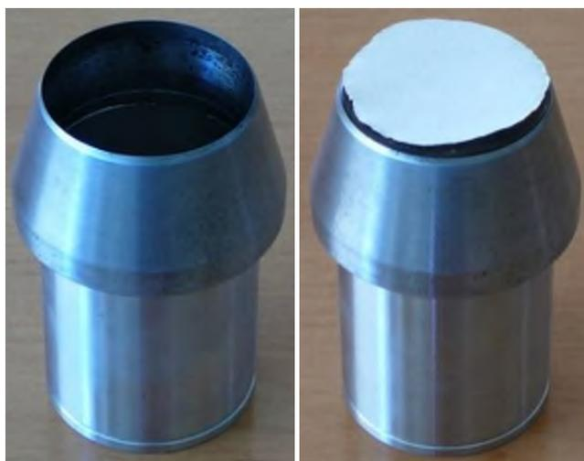
Рисунок 1.30 – Подготовка образца грунта
