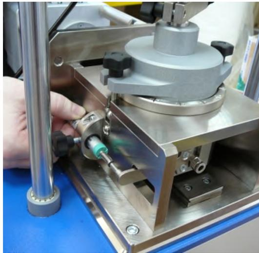
Рисунок 1.15 – Фиксация датчика
