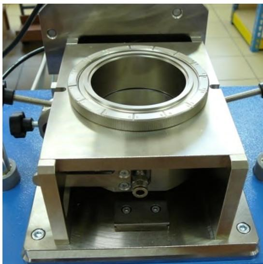
Рисунок 1.10 –Установка верхней плиты
