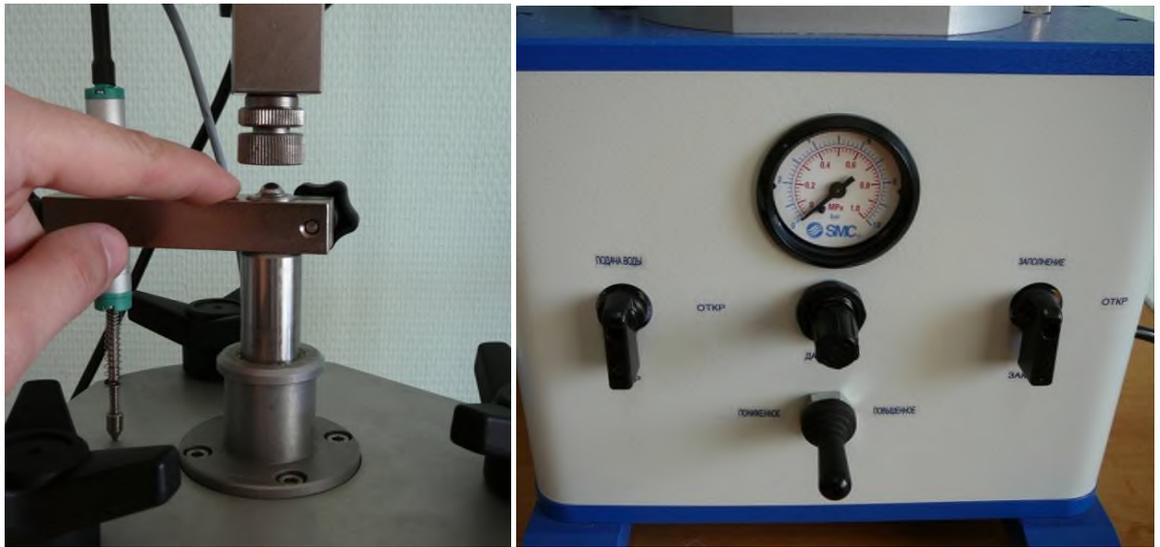
Рисунок 1.43 – Сброс созданного давления и установка положения кранов
