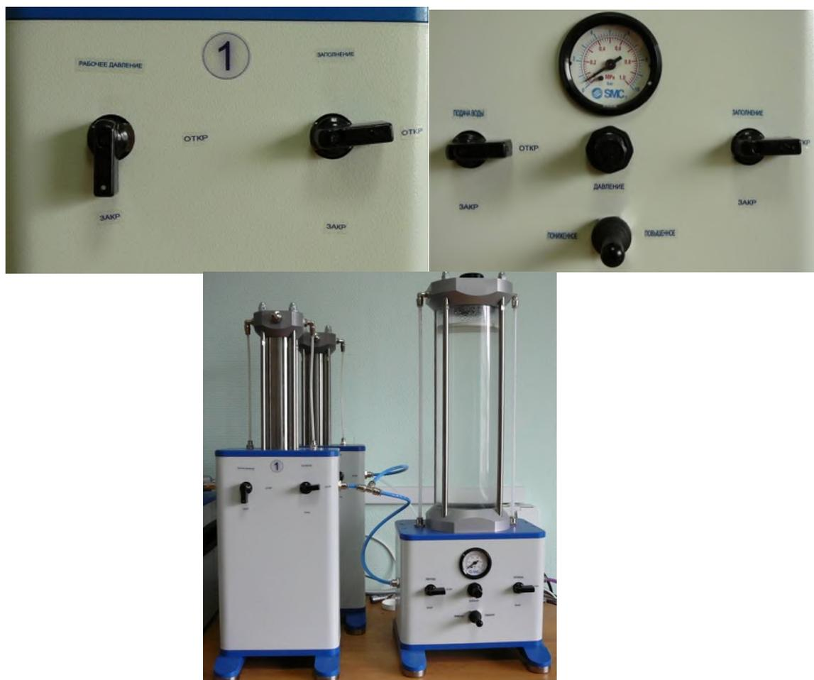
Рисунок 1.48 – Выставление кранов в нужное положение
