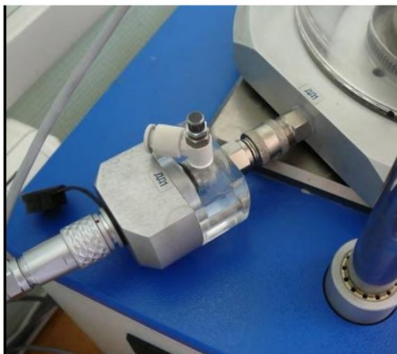
Рисунок 1.38 – Подсоединение датчиков к соответствующим штуцерам
