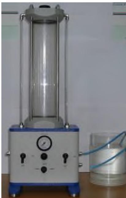
Рисунок 1.24 – Присоединение пневмотрубки к прибору
