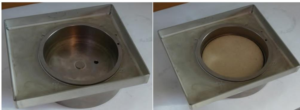
Рисунок 1.6 – Установка каменного фильтра
