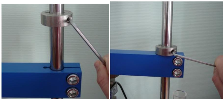
Рисунок 1.5 – Перемещение балки вниз
