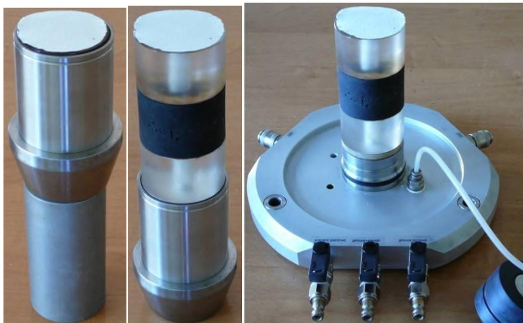
Рисунок 1.31 – Установка образца грунта в основание камеры трехосного сжатия
