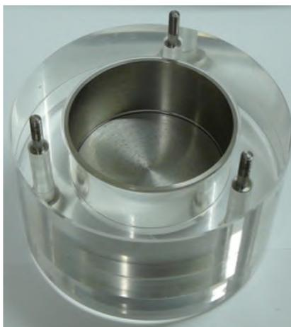
Рисунок 1.17 – Большое срезное кольцо в обойме приспособления
