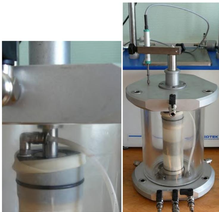
Рисунок 1.36 – Установка штока и датчиков деформации и перемещения
