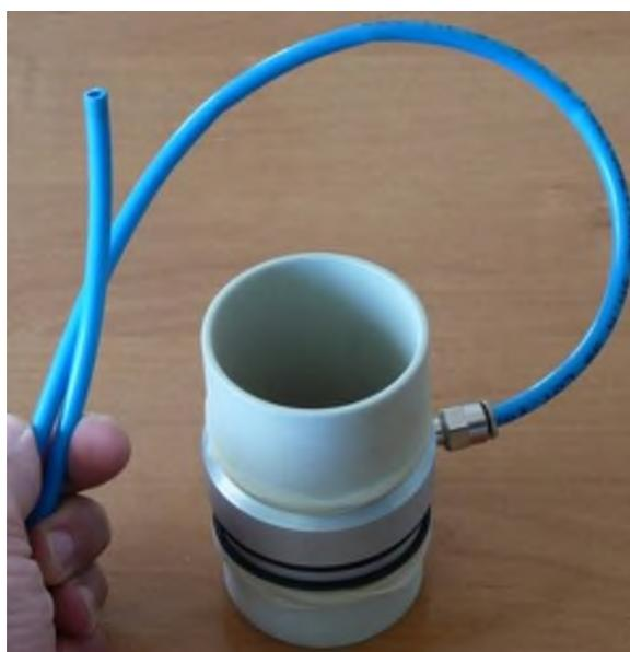
Рисунок 1.32 – Заполнение резиновой оболочки воздухом, для ее плотного прилегания к стенкам расширителя
