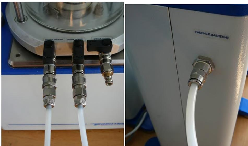
Рисунок 1.39 – Установка пневмотрубки
