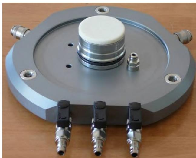
Рисунок 1.27 – Установка пористого диска (каменного фильтра)
