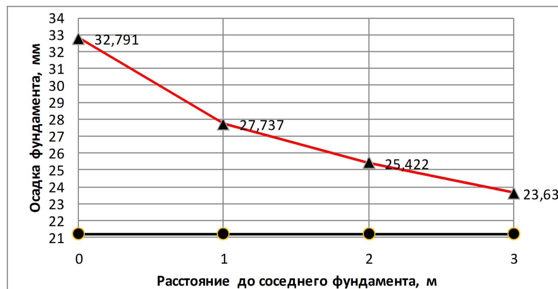
Осадка с учетом взаимного влияния фундаментов в третьем варианте расчета (при P=200 кПа; b2=1м)
