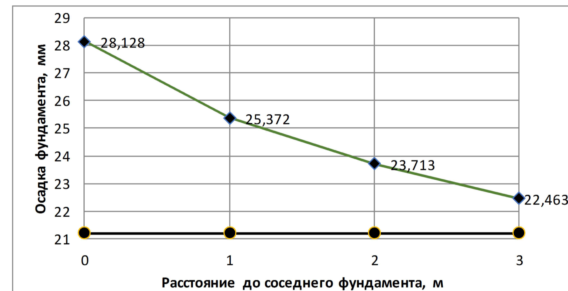
Осадка с учетом взаимного влияния фундаментов в третьем варианте расчета (при P=200 кПа; b2=2м)
