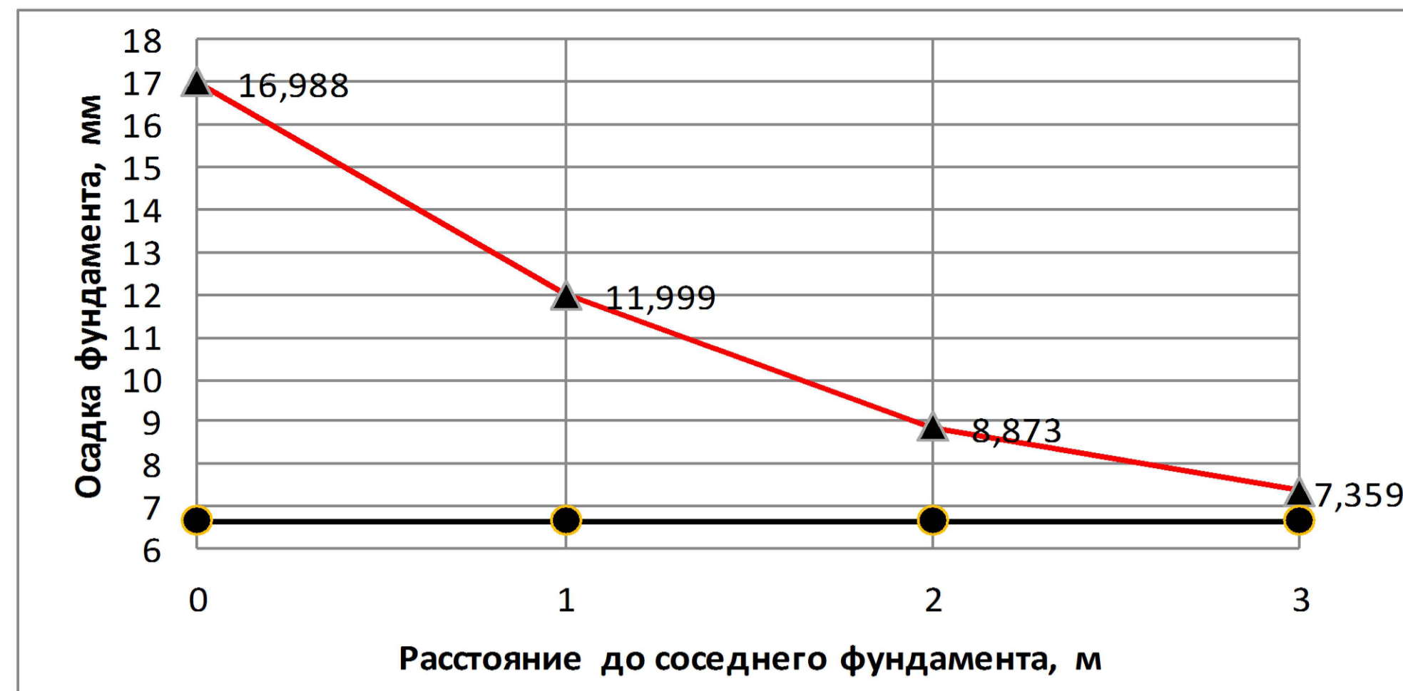
Осадка с учетом взаимного влияния фундаментов во втором варианте расчета (при P=200 кПа)
