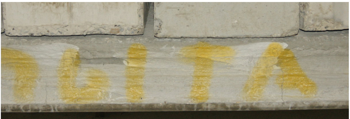
Рис. 3. Общий вид опорных зон и средней части плиты в последний этап нагружения.
