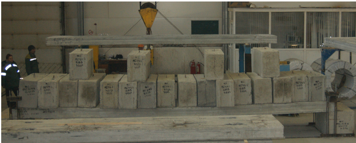
Рис. 2. Предельный этап нагружения плит перекрытия
