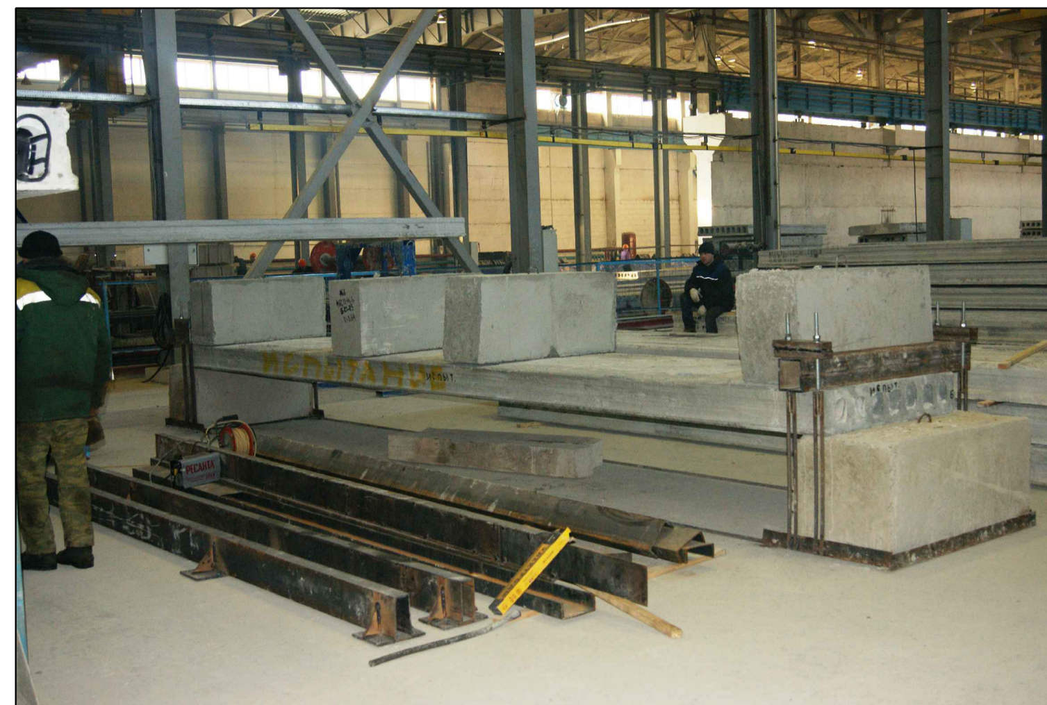
Этап 4 нагружения плиты бетонными блоками
