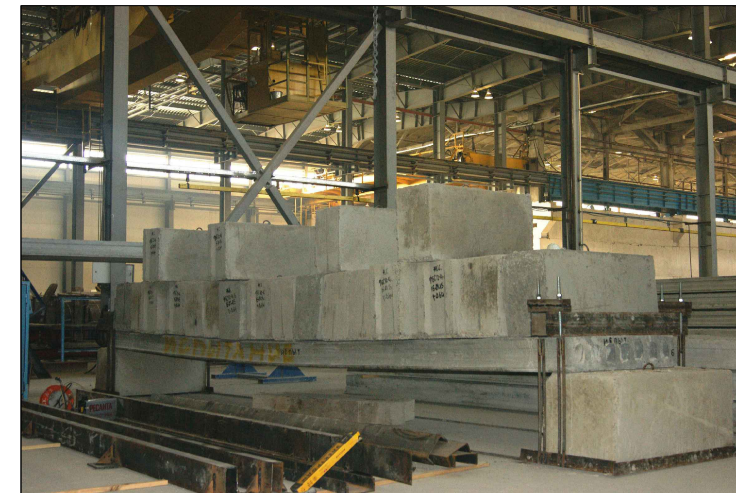
Предельный этап нагружения плиты перекрытия
