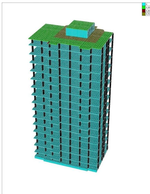
Рис 4. Снеговая нагрузка на здание
