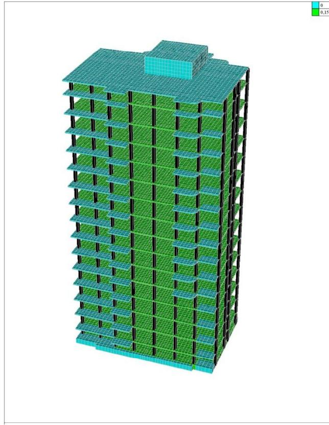
Рис 7. Нагрузка на здание (вес перегородок)
