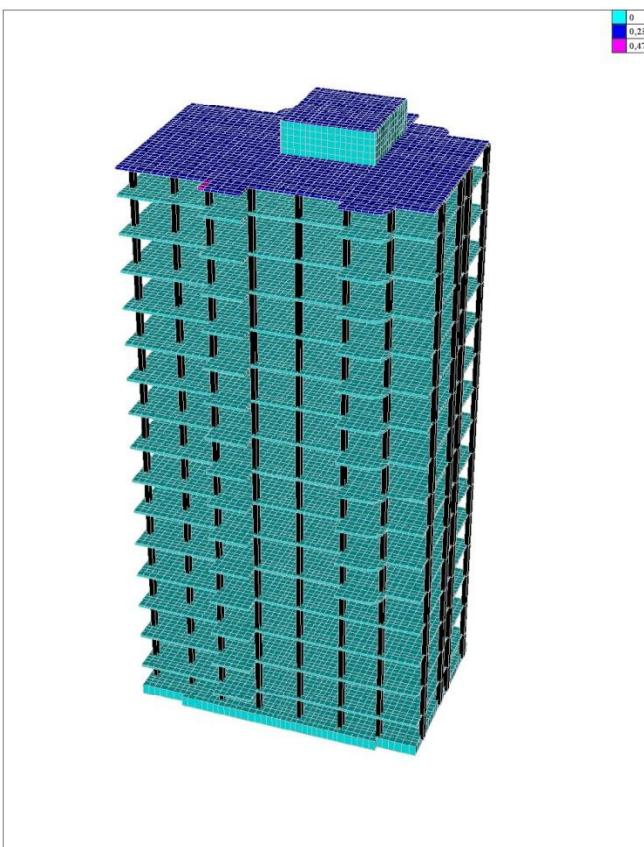
Рис 8. Нагрузка на здание (вес кровельного покрытия)
