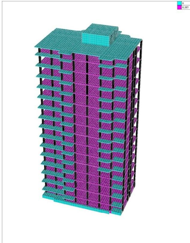
Рис 5. Нагрузка на здание (вес полов и потолков)
