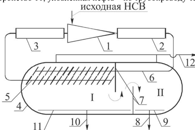
Рис. 2.6. Схема установки БГКО: 1 – гидроциклон; 2, 3 – камеры; 4 – отстойник; 5, 6 – верхний и нижний сливы; 7 – перегородки; 8 – очищенная вода; 9 – сборное устройство очищенной воды; 10 – осадок; 11 – сборное устройство осадка; 12 – трубопровод отвода нефти
