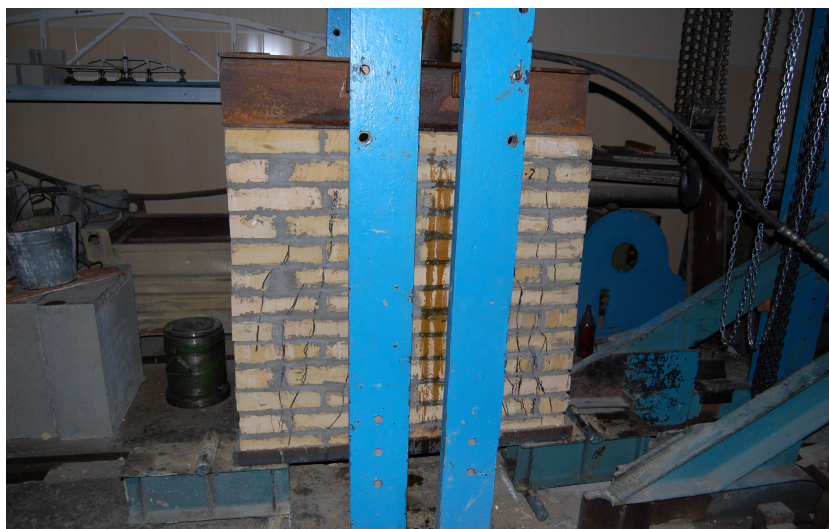
Рис. 3.3. Характер образования трещин в образце БС-1-2.
