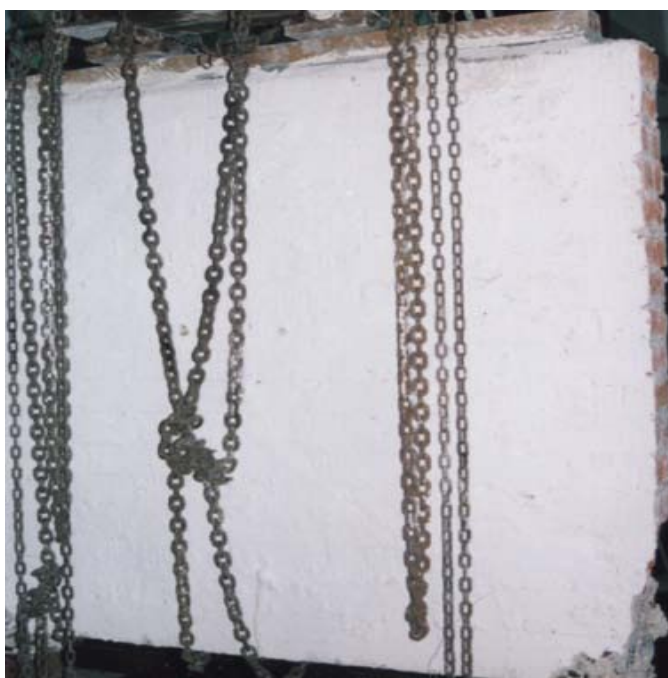
Рис. 3.10. Характер образования трещин в образце БС-2-6.
