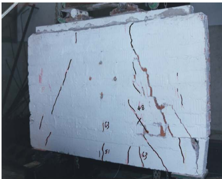
Рис. 3.8. Характер образования трещин в образце БС-2-4.
