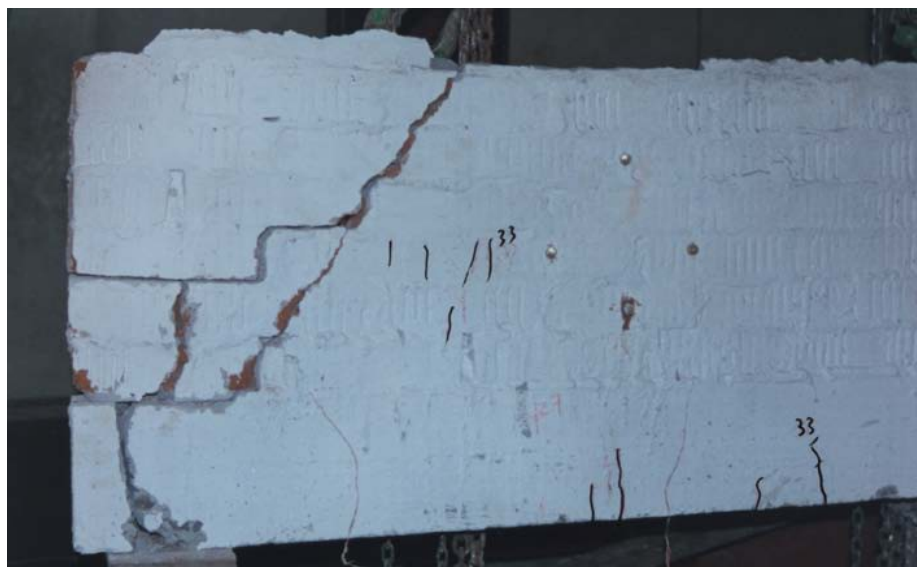
Рис. 3.7. Характер образования трещин в образце БС-2-3.
