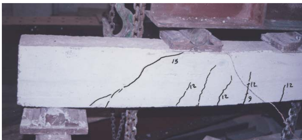
Рис. 3.5. Характер образования трещин в образце БС-2-1.
