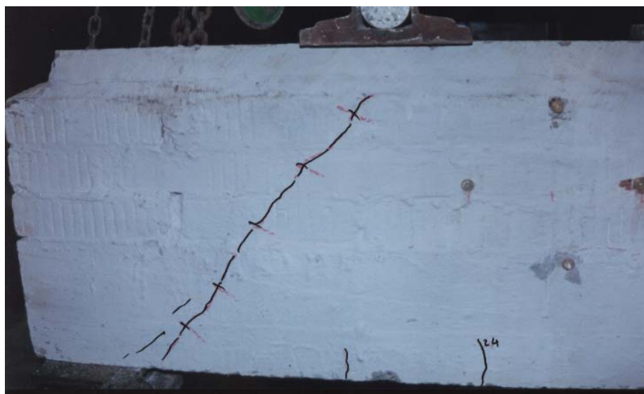
Рис. 3.6. Характер образования трещин в образце БС-2-2.
