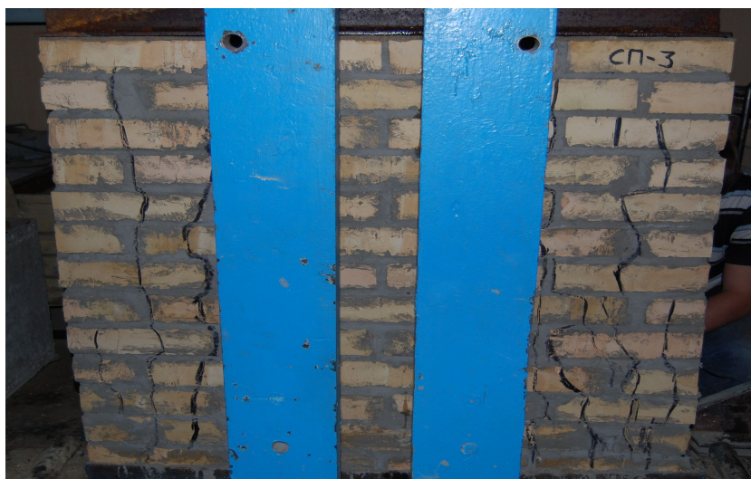
Рис. 3.4. Характер образования трещин в образце БС-1-3.
