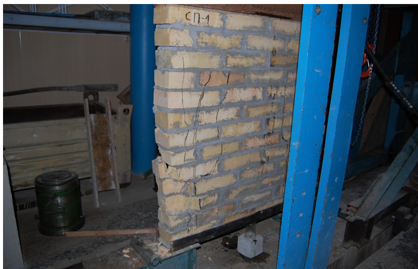
Рис. 3.2. Характер образования трещин в образце БС-1-1.
