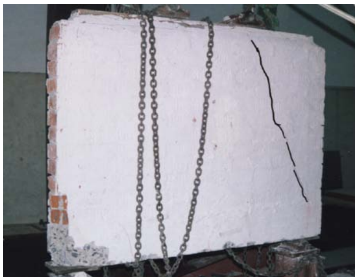
Рис. 3.9. Характер образования трещин в образце БС-2-5.
