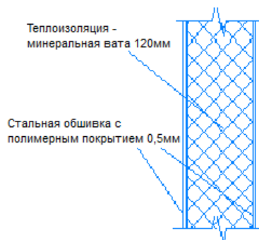
Рис. 1.1. Расчётная схема стены
