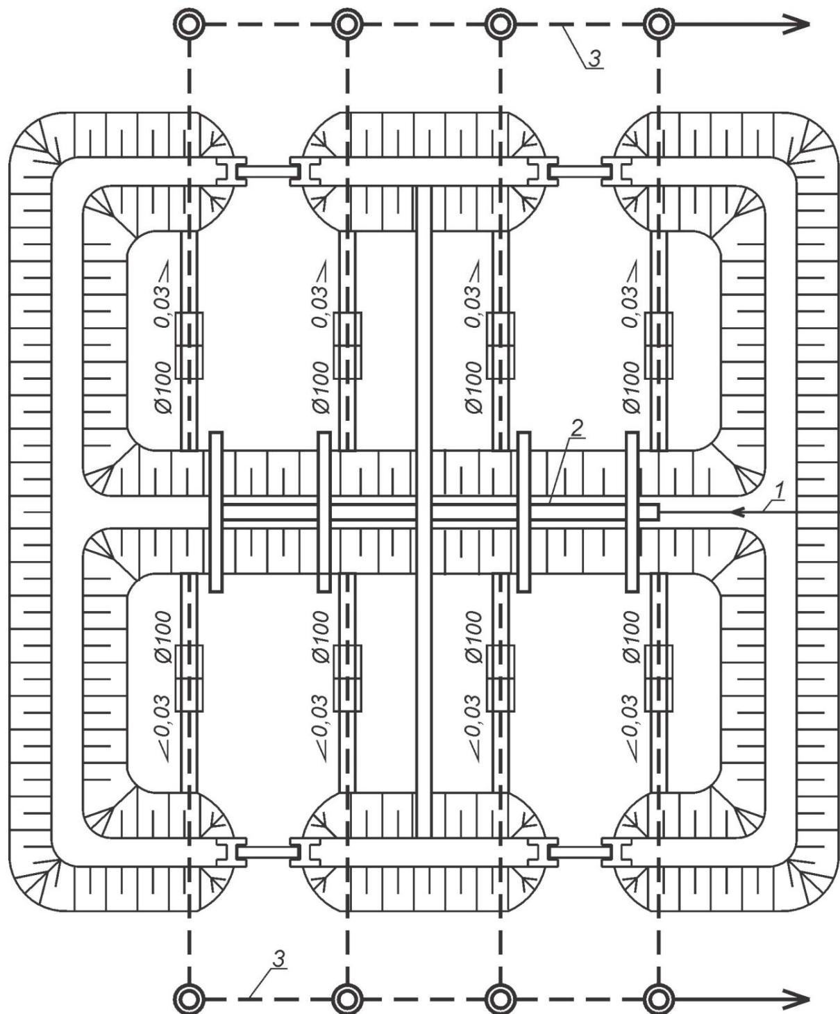
Рис. 27. Схема песковых площадок:
