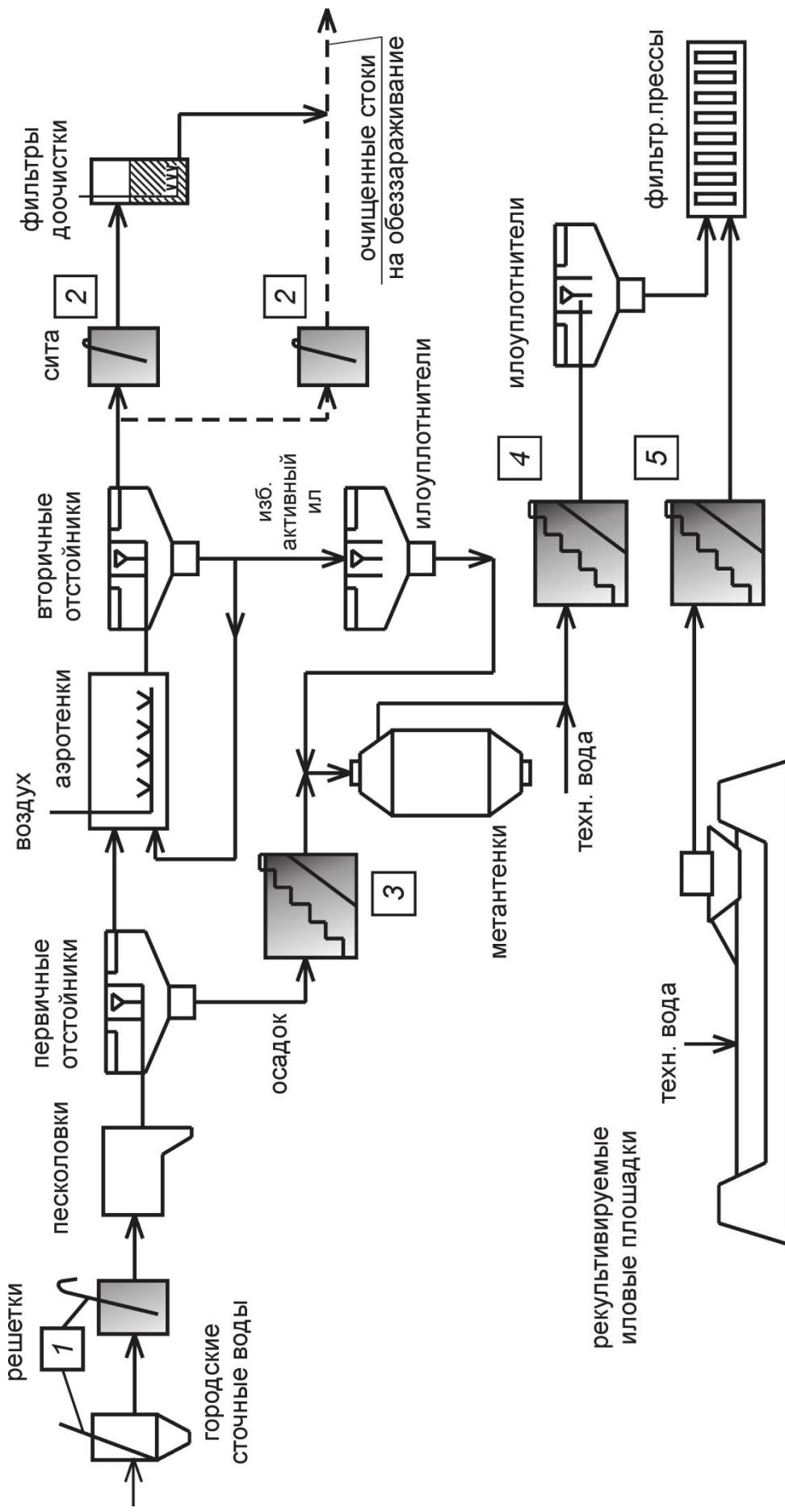
Рис. 14. Перспективная схема установки решеток и сит на станциях аэрации (места установки решеток и сит):
