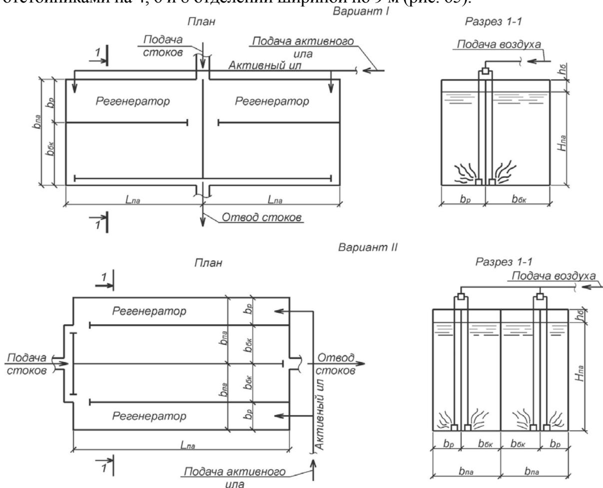
Рис.64. Расчетные схемы отдельно стоящих преаэраторов
