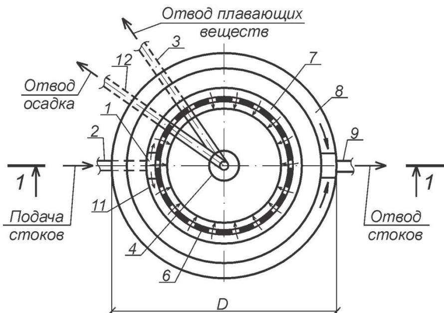
Рис. 38. Схема отстойника с нисходяще-восходящим потоком:
