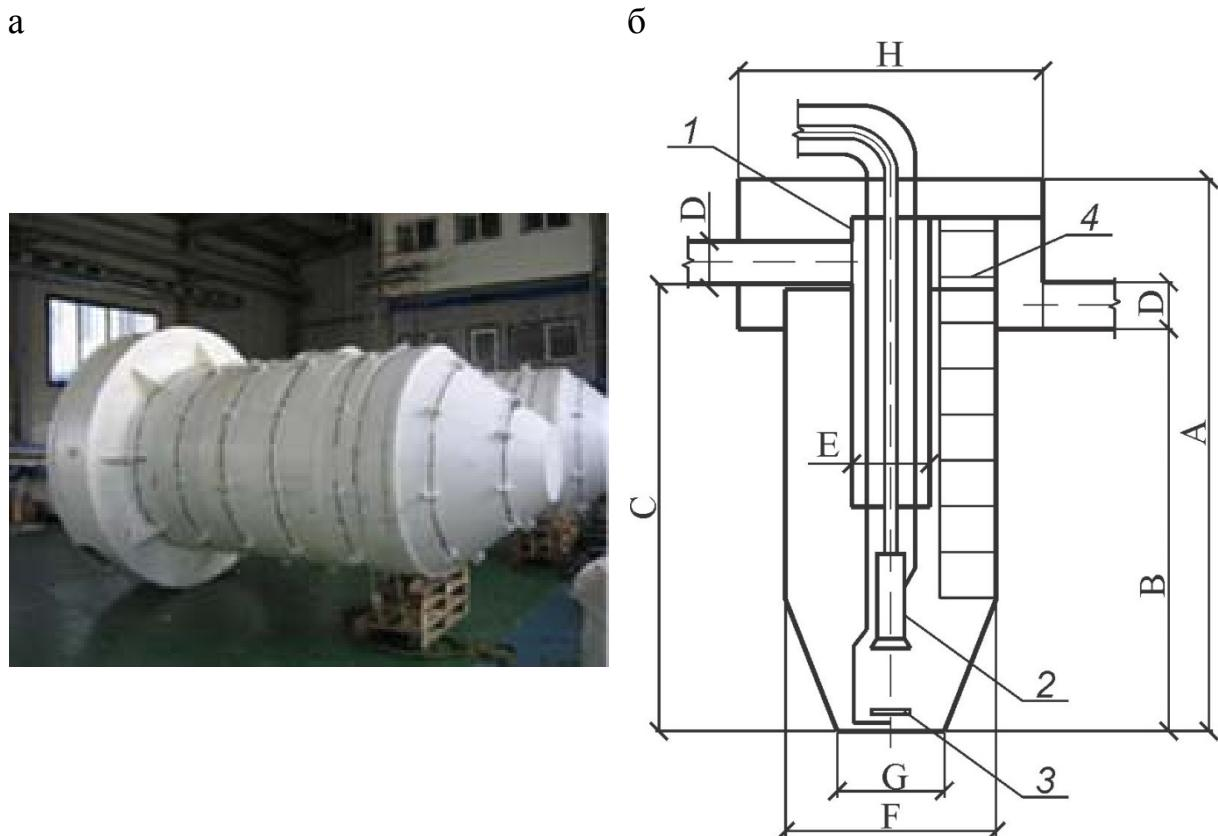
Рис. 26. Схема песколовки вертикального типа (серия РВТ):
