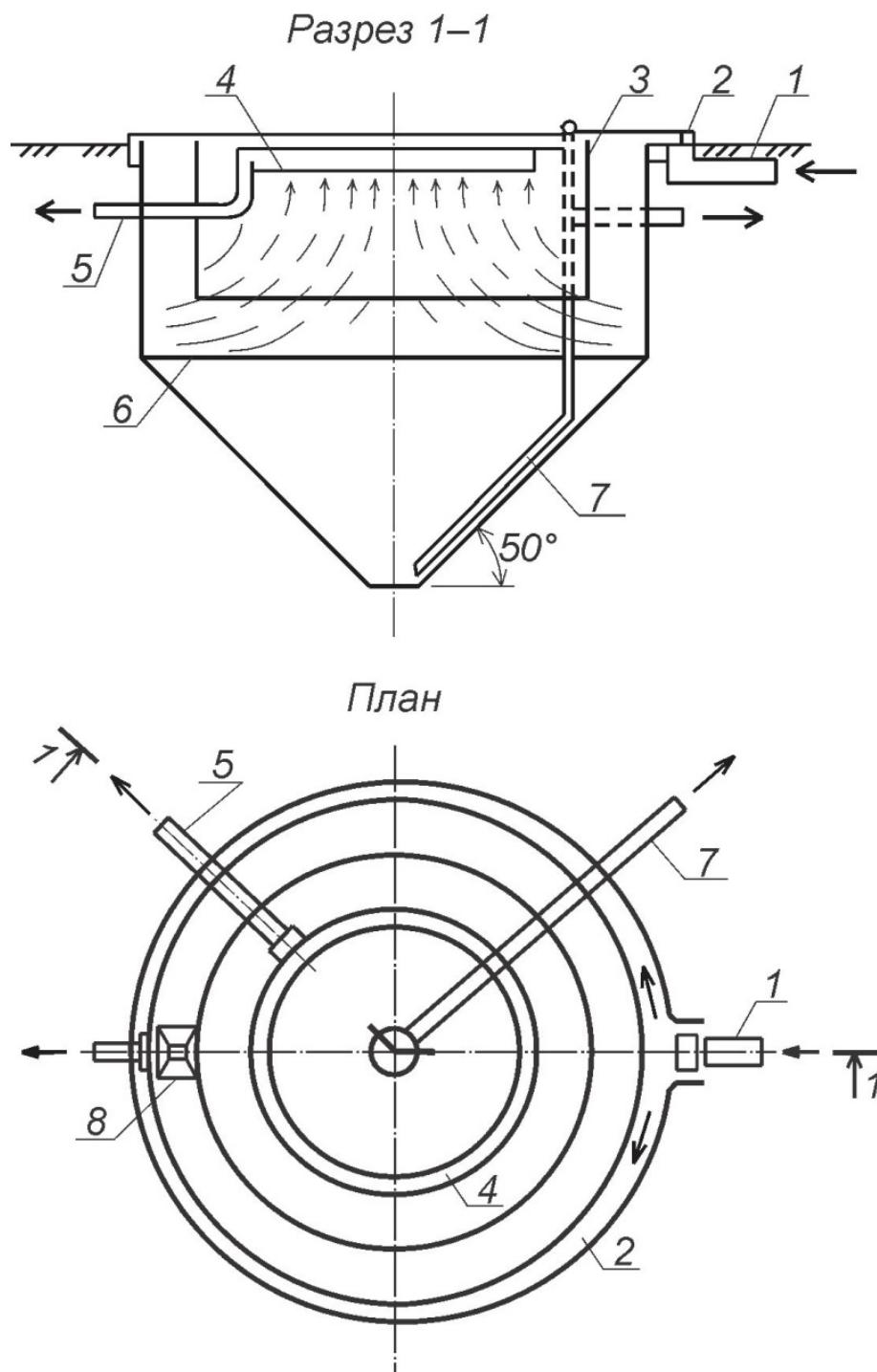
Рис. 39. Вертикальный отстойник с периферийным впускным устройством:
