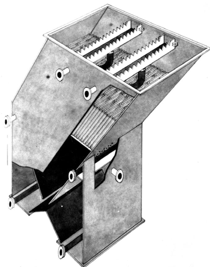
Рис. 57. Тонкослойный полочный отстойник
