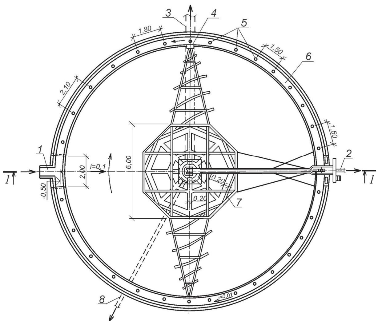
Рис. 45. Радиальный отстойник с периферийной подачей сточных вод (3-й тип) [10]:
