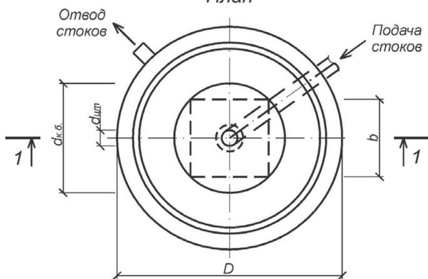
Рис. 63. Расчетная схема биокоагулятора
