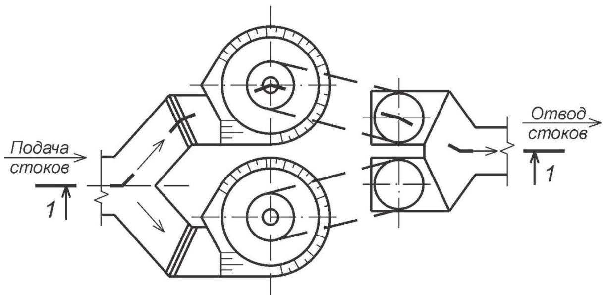
Рис. 16. Схема установки решеток-дробилок
