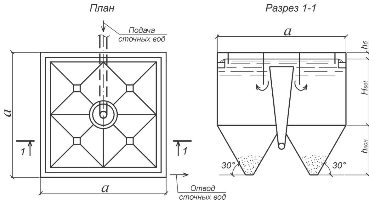
Рис. 43. Расчетная схема радиального (квадратного) в плане отстойника
