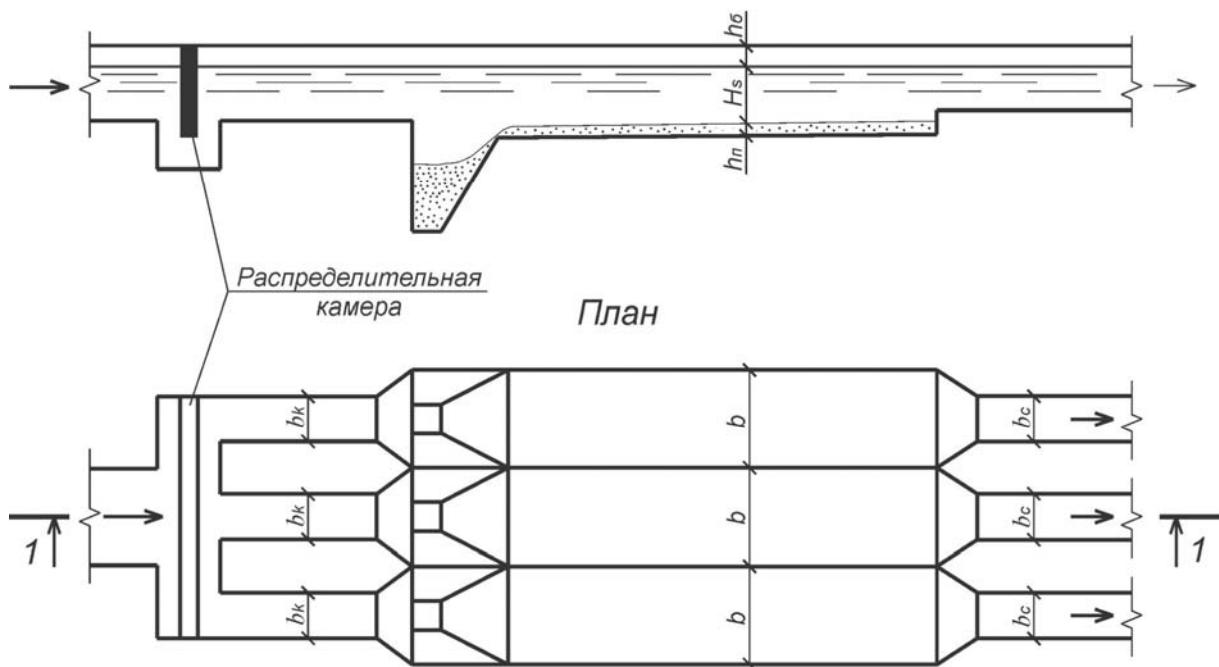
Рис. 18. Схема горизонтальных песколовок
