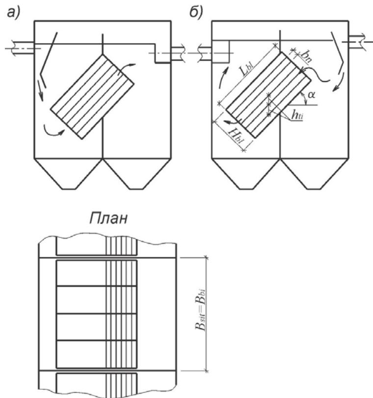
Рис. 53. Схема тонкослойного отстойника, работающего по противоточной схеме удаления примесей [18]:
