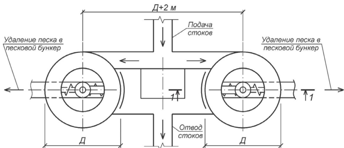
Рис. 23. Схема тангенциальных песколовок
