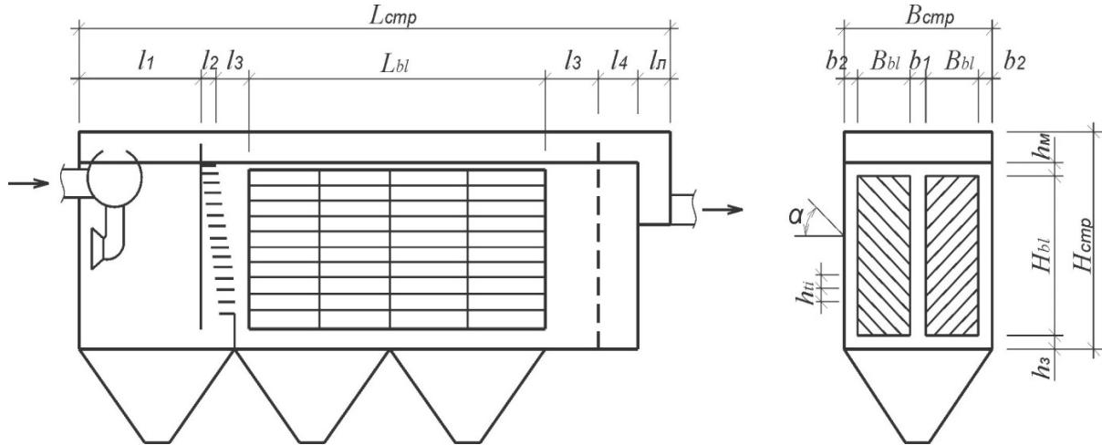
Рис. 52. Схема тонкослойного отстойника, работающего по перекрестной схеме удаления осадка [18]
