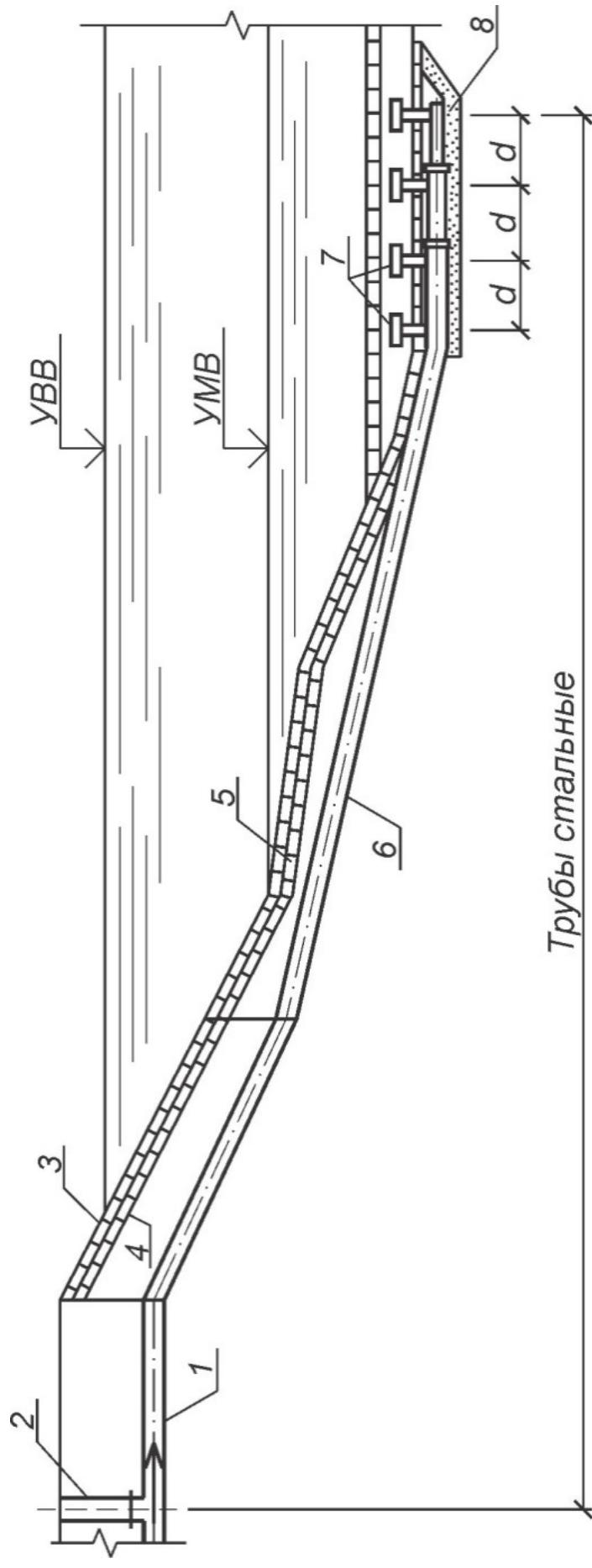
Рис. 34. Схема руслового рассеивающего выпуска в реку:
