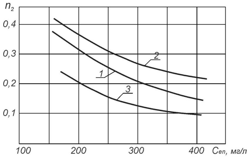
Рис. 40. Зависимость показателя степени  $n_2$  от исходной концентрации взвешенных веществ в городских сточных водах при эффекте отстаивания:
