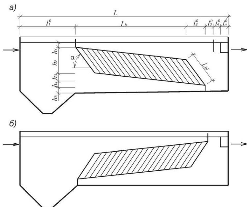
Рис. 54. Схема отстойника, оборудованного тонкослойными блоками и работающего по противоточной схеме удаления примесей [18]:
