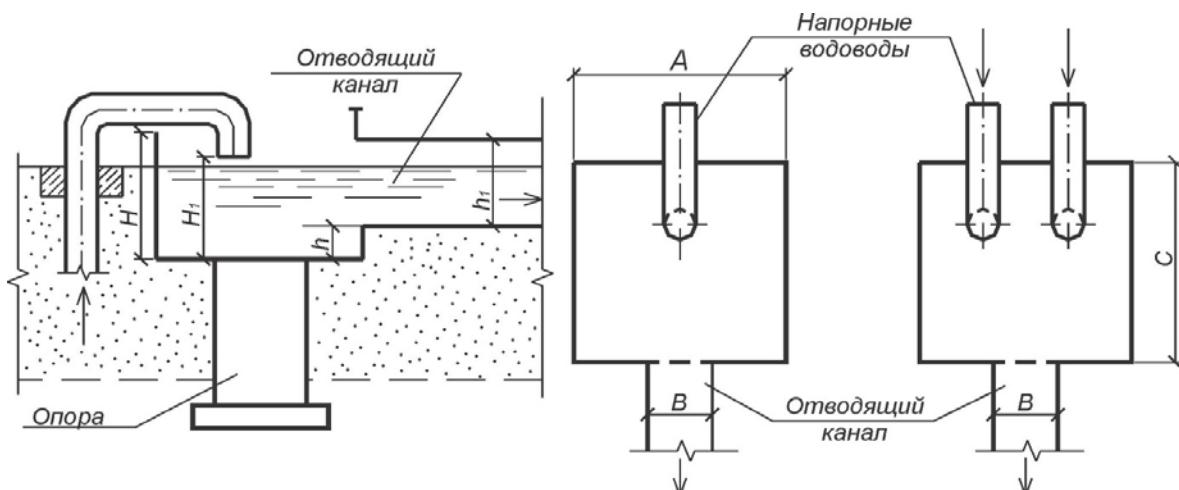
Рис. 1. Приёмная камера
