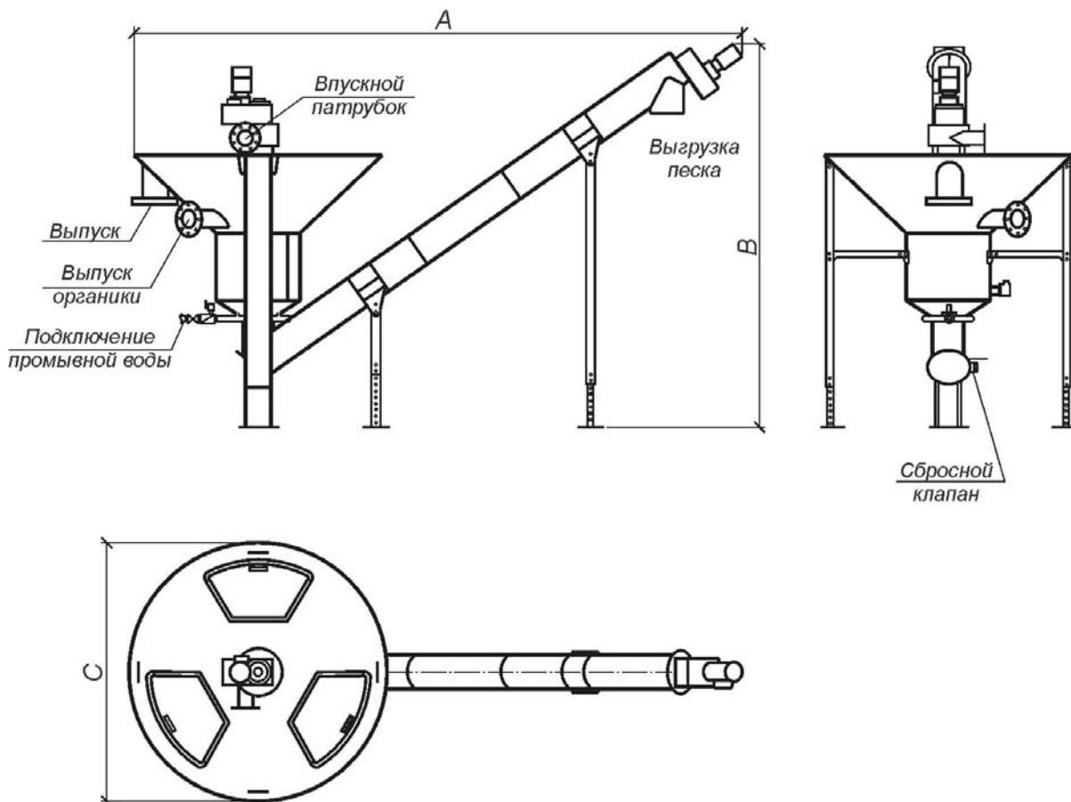
Рис. 31. Установка по промывке песка SWA «Meva»
