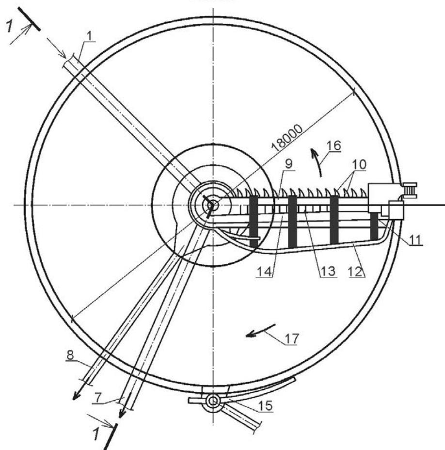
Рис. 44. Отстойник с вращающимся сборно-распределительным устройством (2-й тип) [15]:
