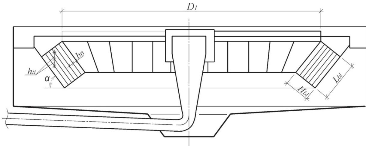
Рис. 55. Схема радиального отстойника, дополненного тонкослойными блоками (модулями) [18]
