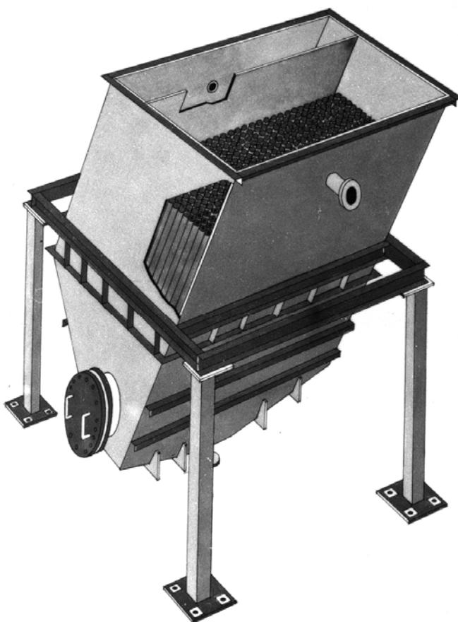
Рис. 59. Отстойник тонкослойный трубчатый
