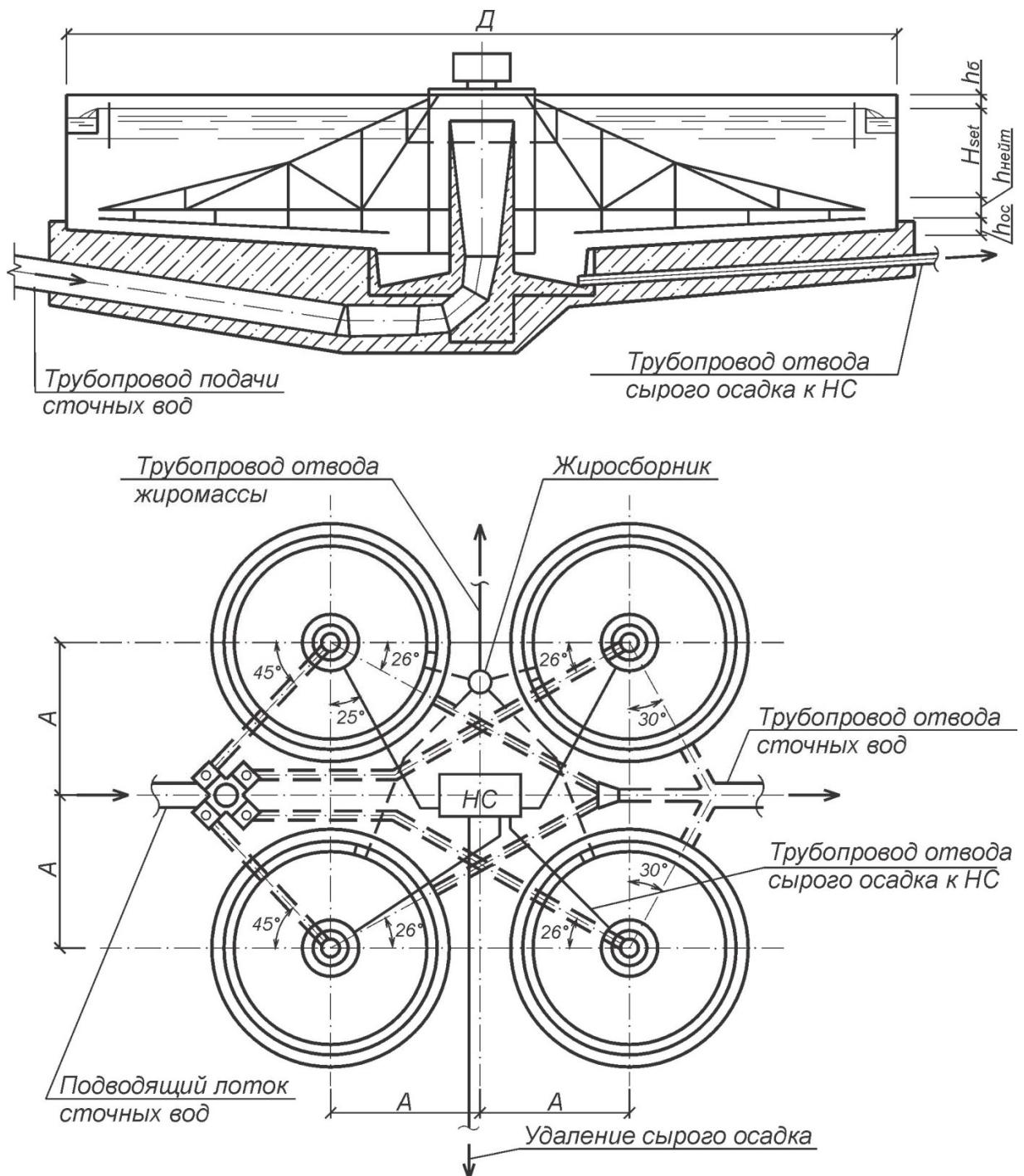
Рис. 42. Расчетная схема первичного радиального отстойника (1-й тип) и типовая компоновка 4-х отстойников
