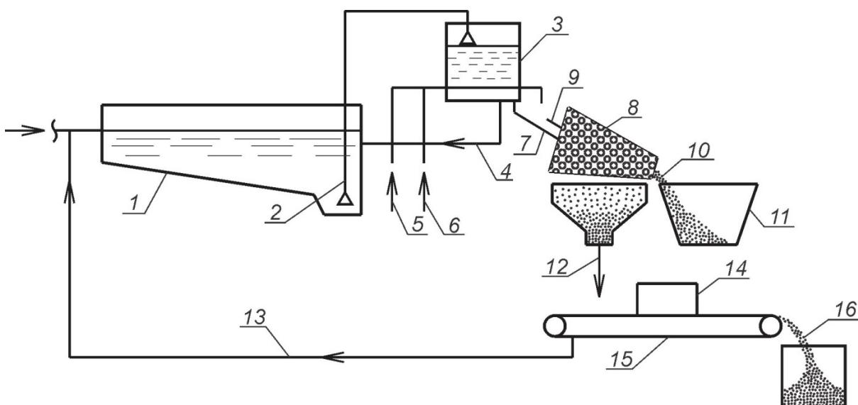
Рис. 29. Схема узла по обработке осадка из песколовок:
