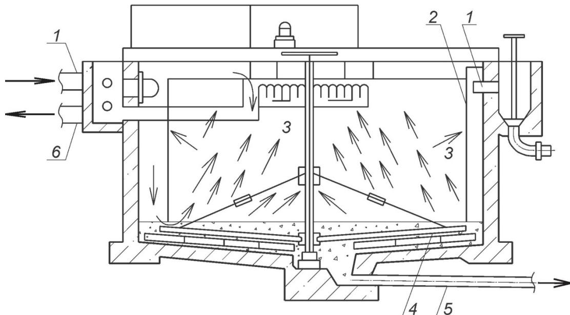
Рис. 46. Радиальный отстойник с периферийной подачей сточной воды, применяемый в США (фирма «Линк-Бельт»):
