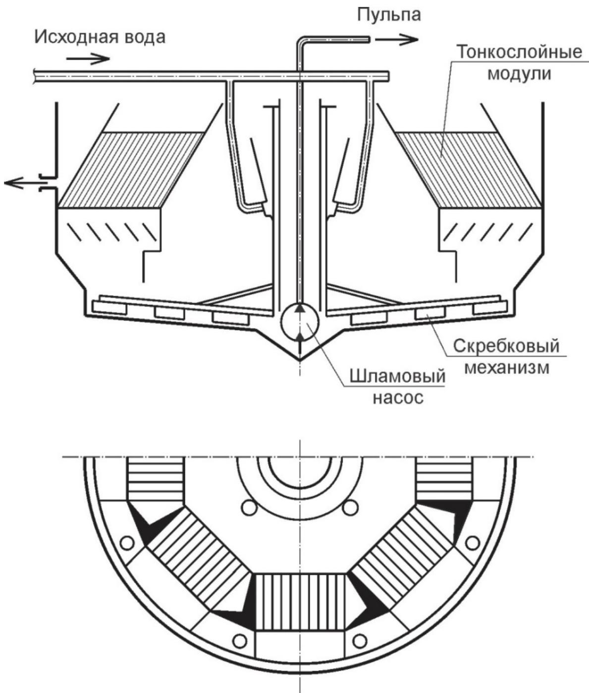
Рис. 56. Радиальный тонкослойный отстойник, работающий по прямоточной схеме удаления осадка
