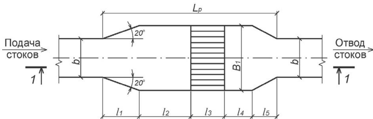
Рис.15. Схема установки решетки
