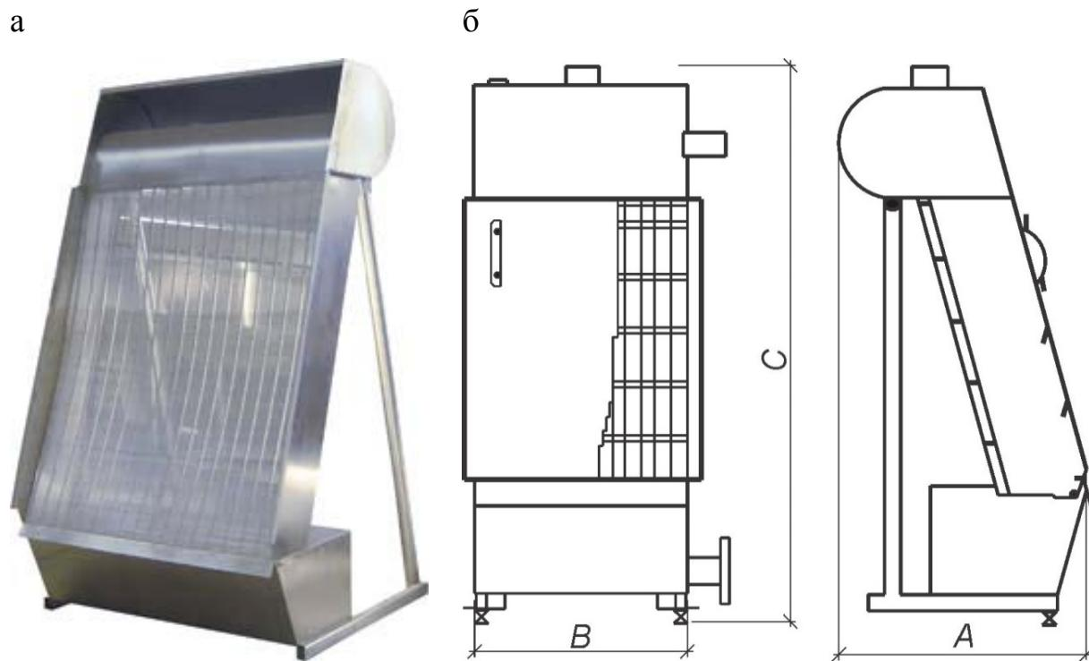
Рис. 10. Устройство фильтрующее самоочищающееся:
