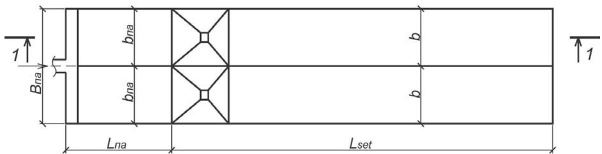
Рис.65. Расчетная схема блока преаэратор – отстойник
