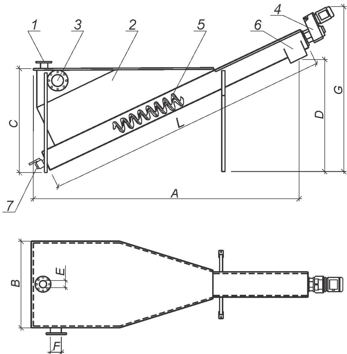
Рис. 30. Сепаратор песка компании «Meva»:
