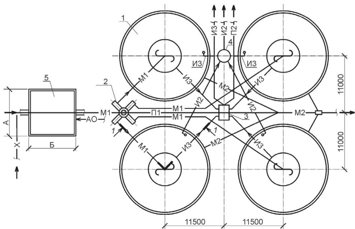
Рис. 49. Разрез и компоновочная схема радиальных отстойников со встроенной камерой хлопьеобразования:
