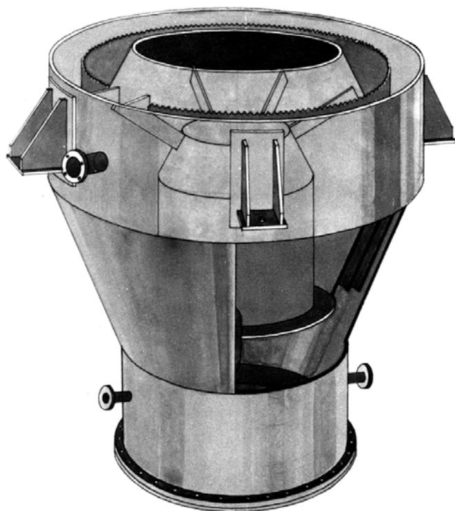
Рис. 58. Тонкослойный коаксиальный отстойник
