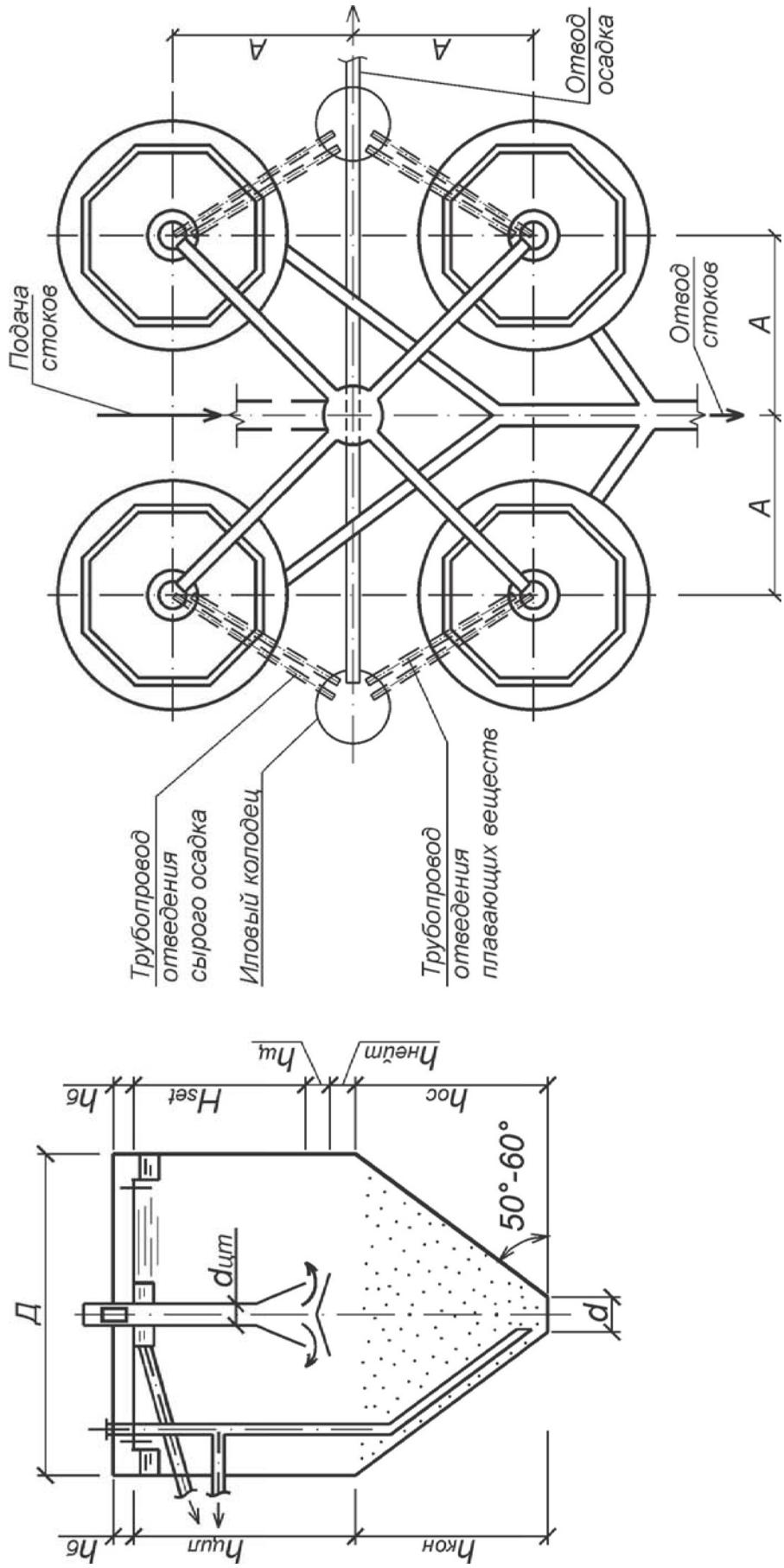
Рис. 37. Расчетная схема отстойника и типовая компоновка блока отстойников
