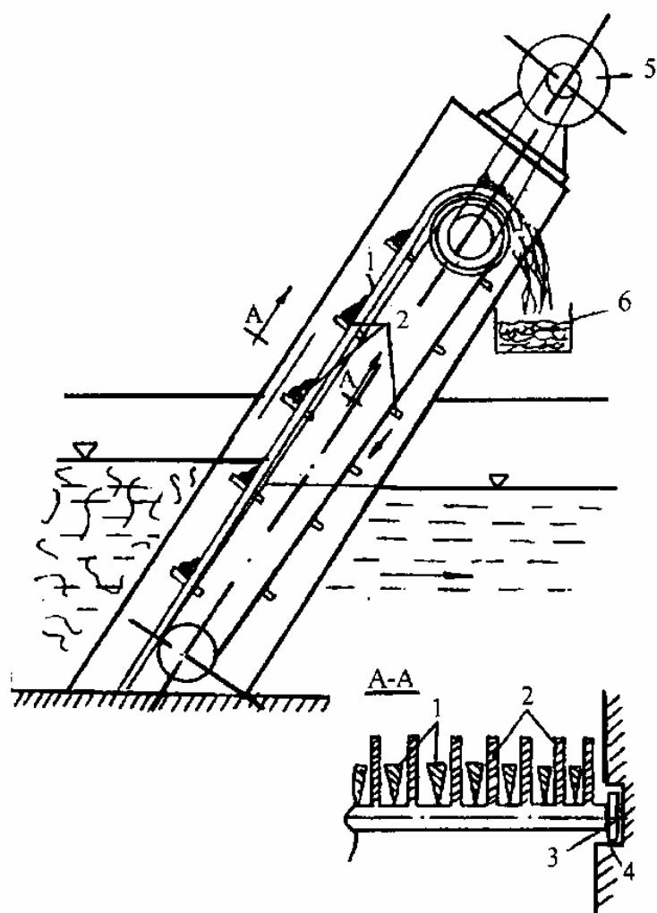
Рис. 2. Схема решетки фирмы «Джоунс энд Аттвуд» (Великобритания):
