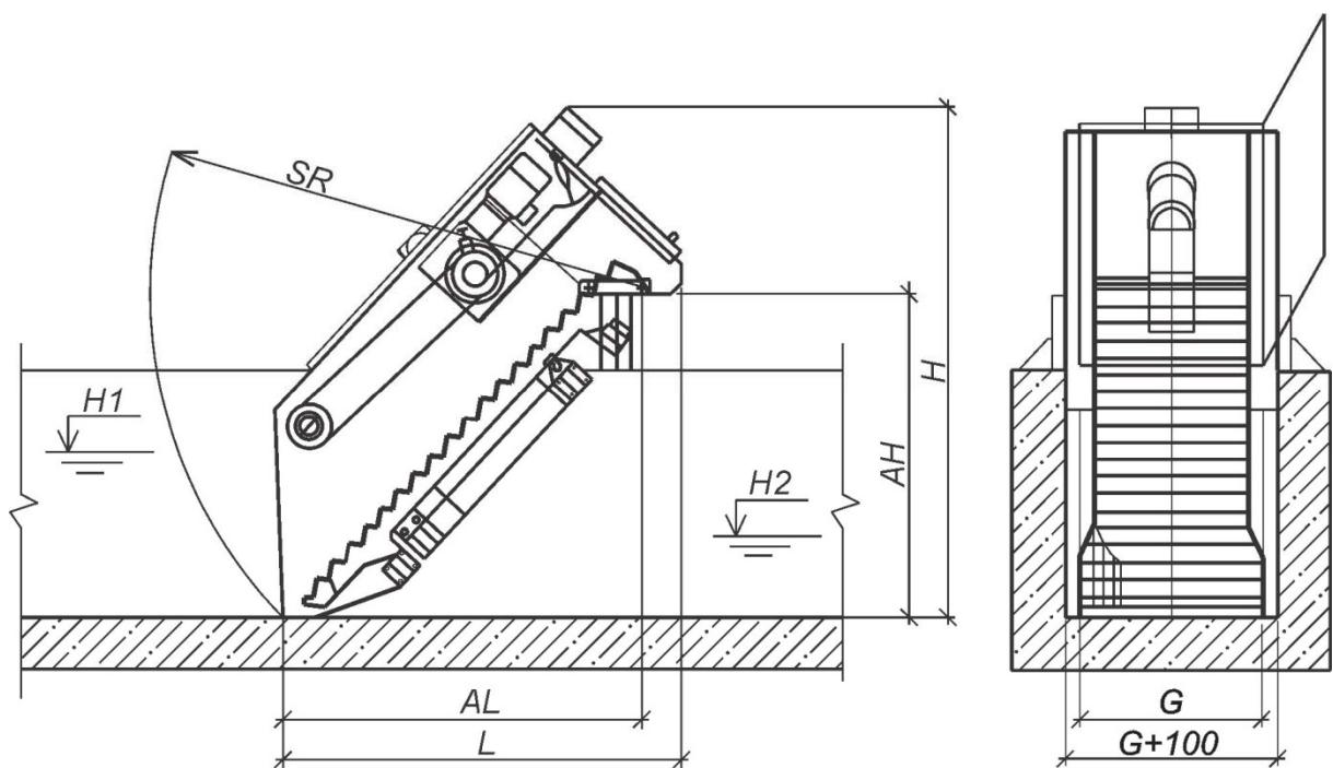
Рис. 7. Конструктивная схема решетки Meva Rotoscreen RS
