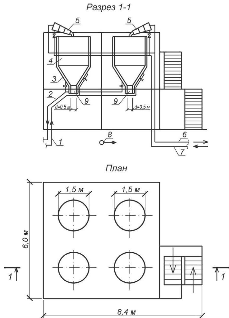
Рис. 28. Площадка песковых бункеров диаметром 1,5 м.
