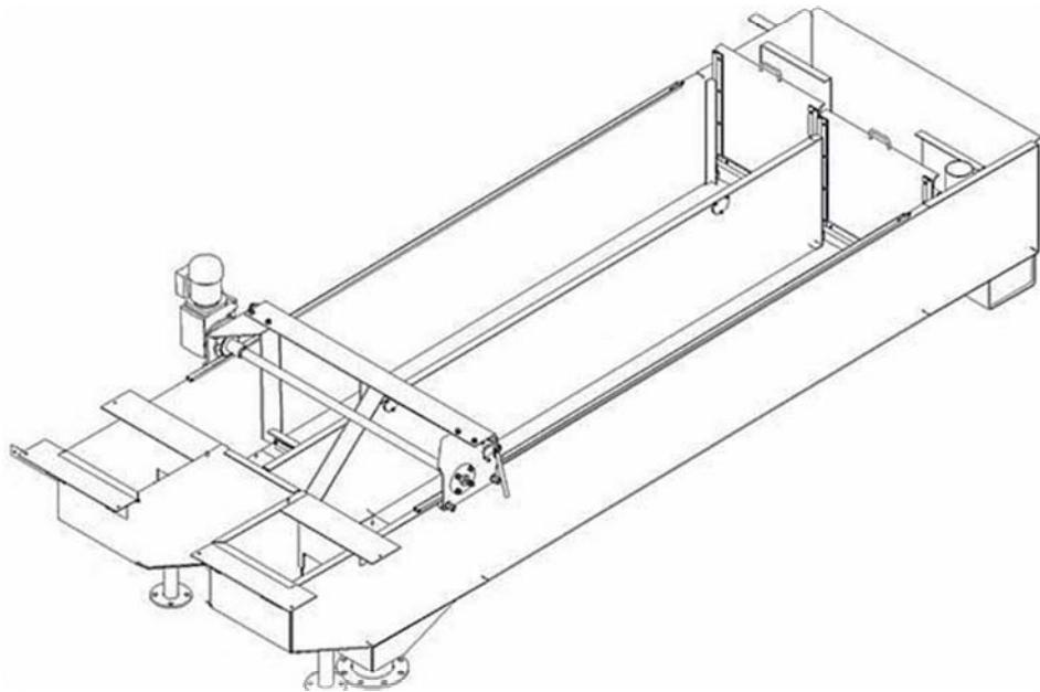
Рис. 19. Конструктивная схема горизонтальных песколовок
