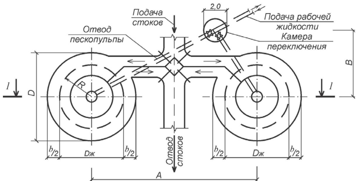
Рис. 20. Схема горизонтальных песколовок с круговым движением воды
