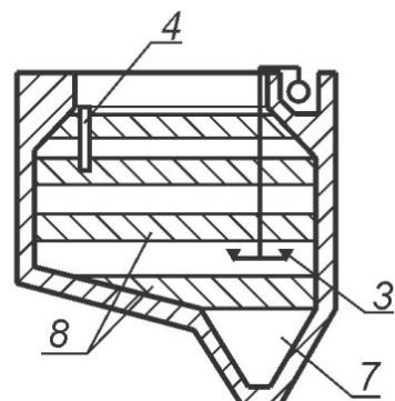
Рис. 22. Схемы аэрируемых песколовок, применяемых в США:
