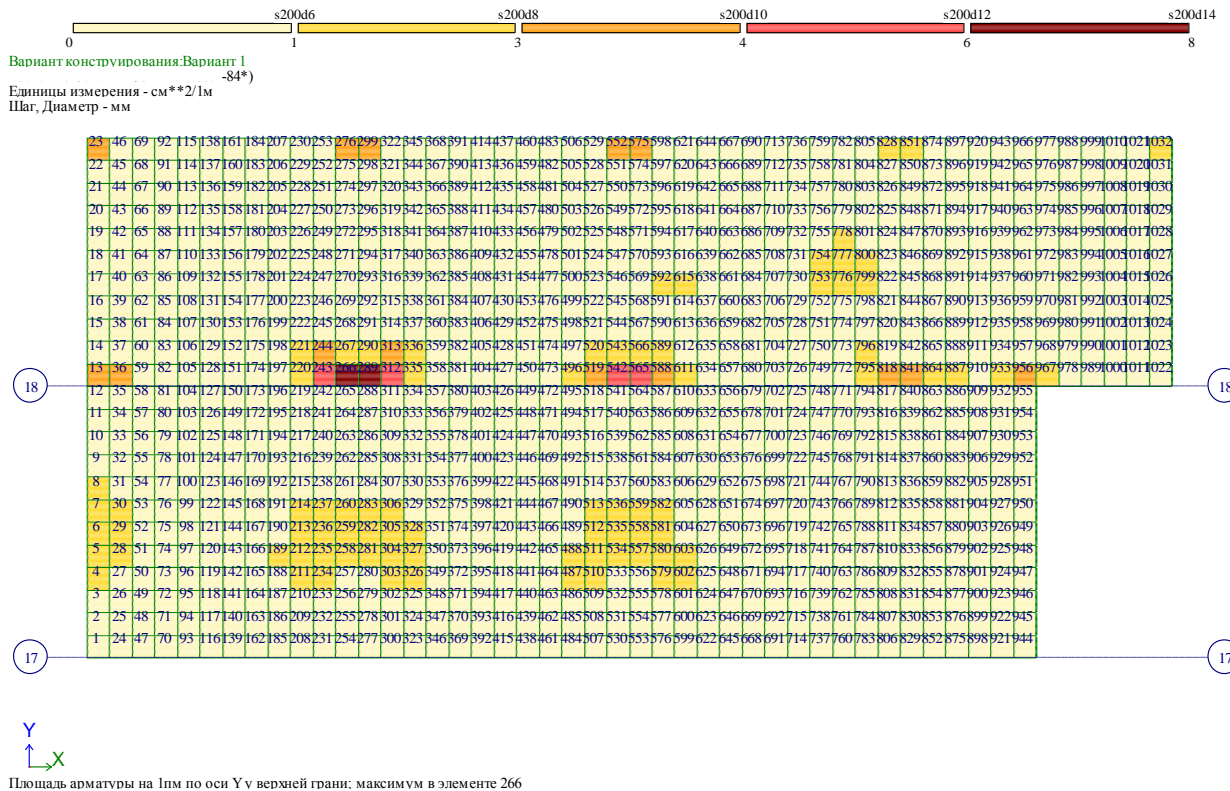
Рис.26. Площадь верхней арматуры вдоль оси Y1
