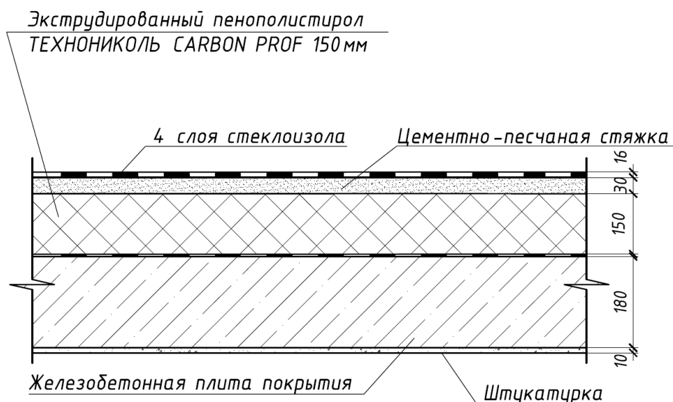
Рисунок 2. Схема ограждающей конструкции покрытия
