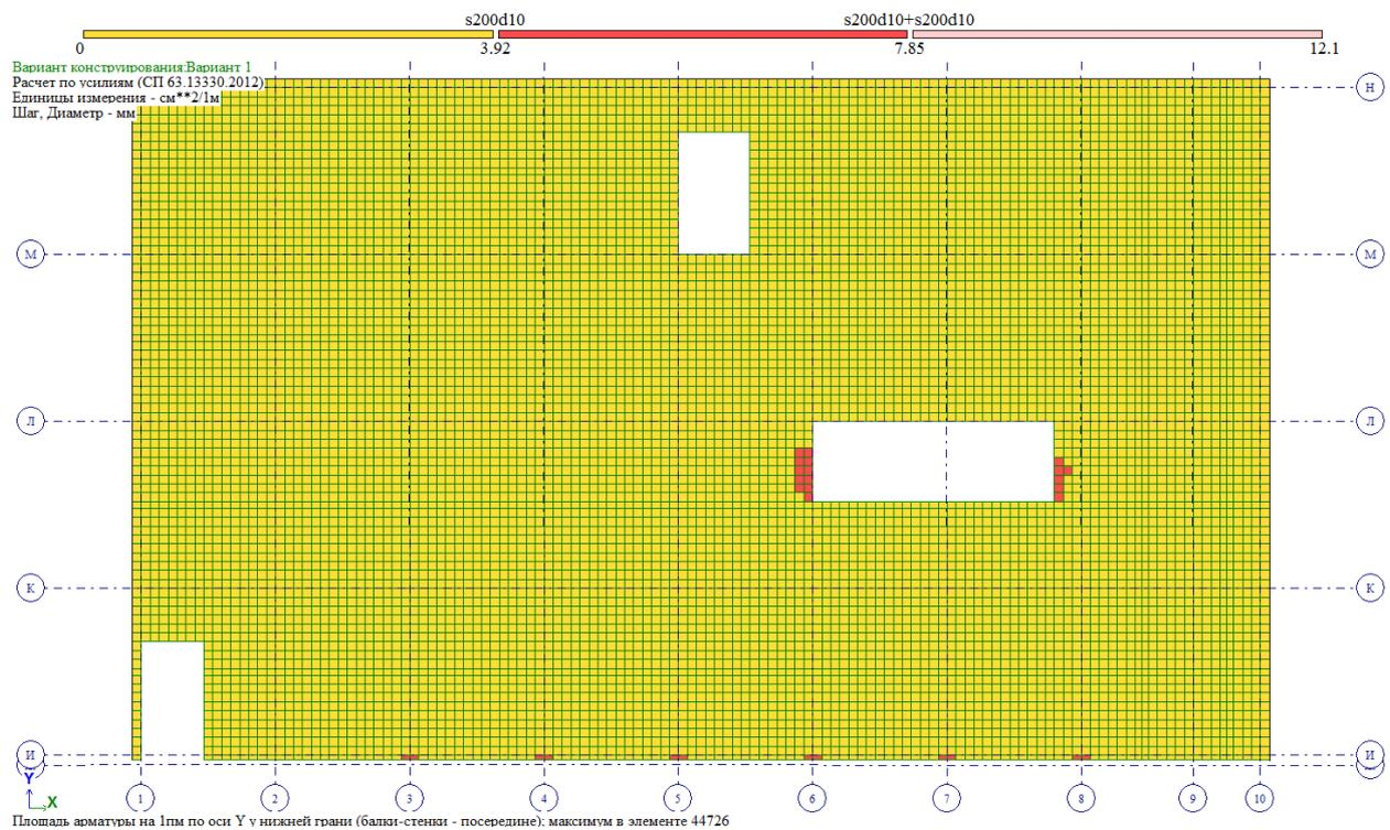
Рис.. Армирование плиты на отм. 0,000. Нижний ряд в направлении Y
