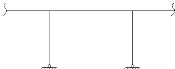
В продольном направлении жесткость и неизменяемость рамы обеспечивается жестким защемлением колонн в фундаментах. Крепление ригелей в данном случае шарнирное.
