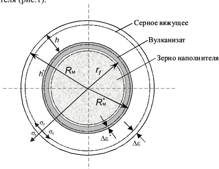
Рис. 1. Структурная модель серного композита на аппретированном наполнителе:
