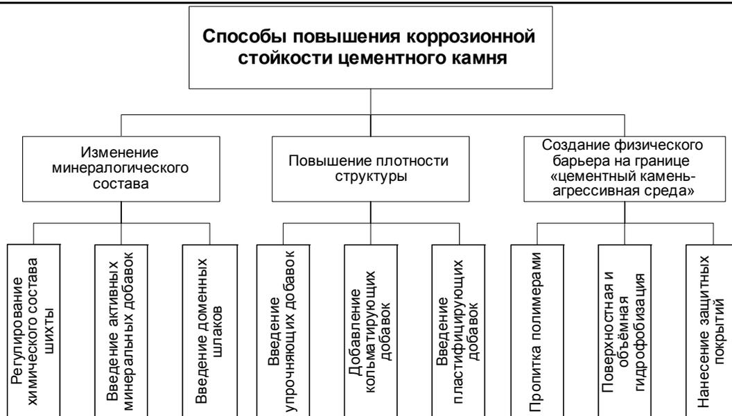
Рис. 1. Способы повышения химической стойкости портландцементного камня
