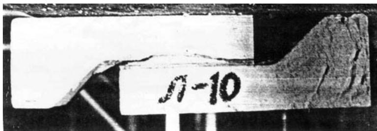
Рис. 2. Характерное разрушение клеевого бетонного сопряжения при сдвиге
