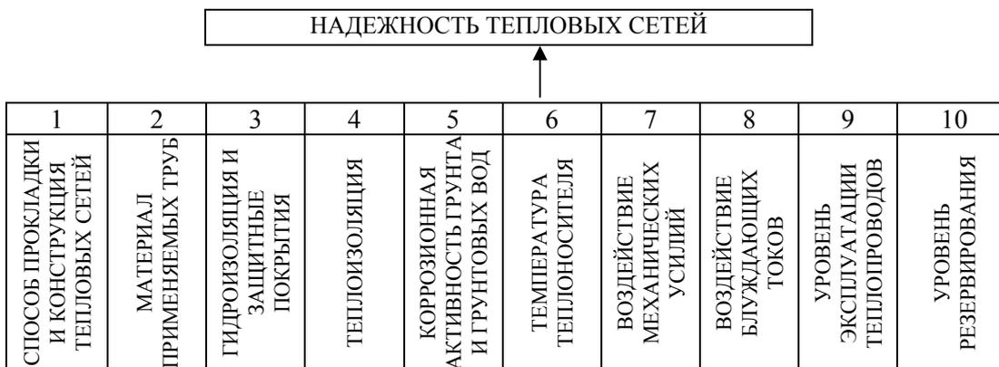
Рис. 2. Предпосылки снижения надежности тепловых сетей
