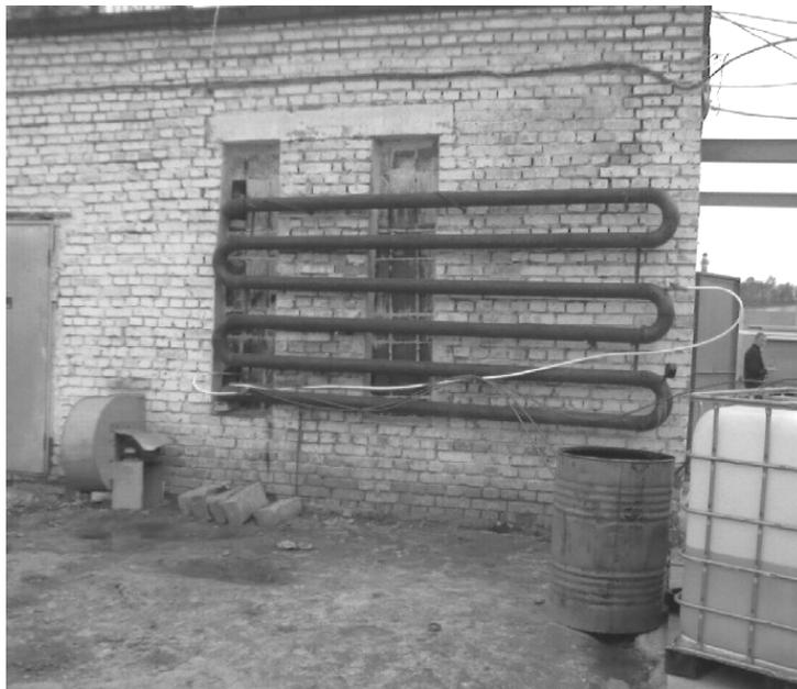
Рис.1. Общий вид трубчатого смесителя
