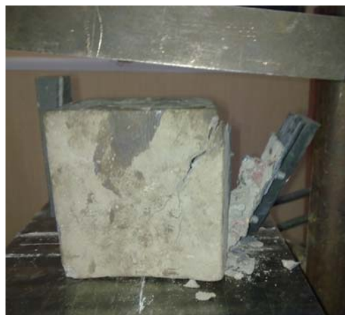
Рис. 3. Характер разрушения клеевого соединения на шпонках при срезе
