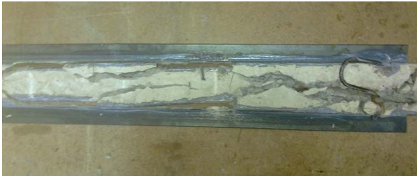
Рис. 5. Характер разрушения усиленных балок: а – балка Бу-1; б – балка Бу-2; в – продольное расслоение бетона сжатой зоны при разрушении балки Бу-1 (вид сверху)
