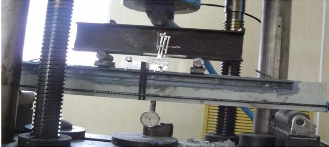
Рис. 4. Фрагмент испытания усиленной балки (Бу-1)
