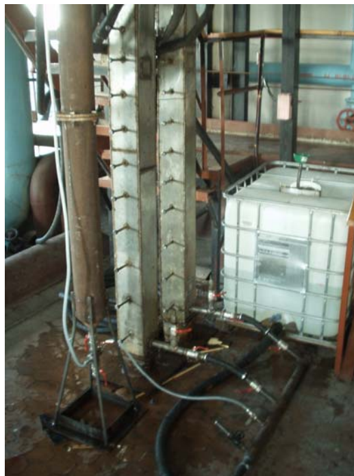
Рис. 2. Экспериментальная полупромышленная установка по очистке воды водохранилища поселка Красный Брод
