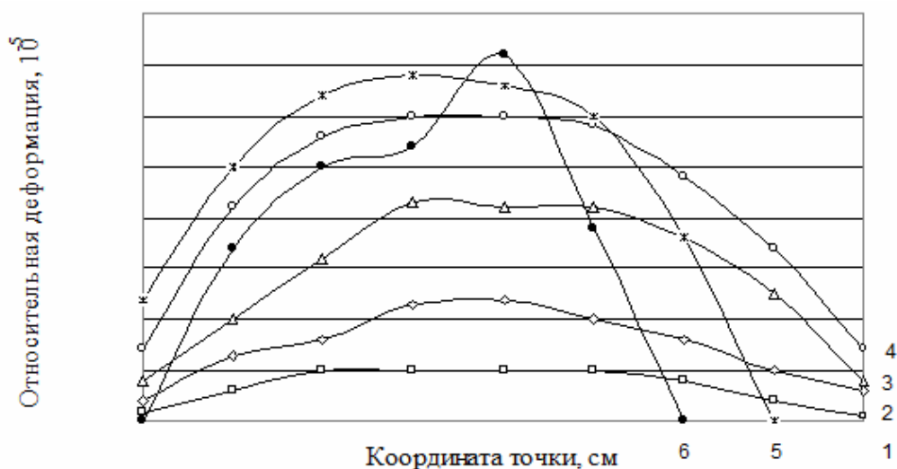
Рис. 2. Изменение относительной деформации по длине пластины для образцов типа БУРС-16 (сжатая пластина):
