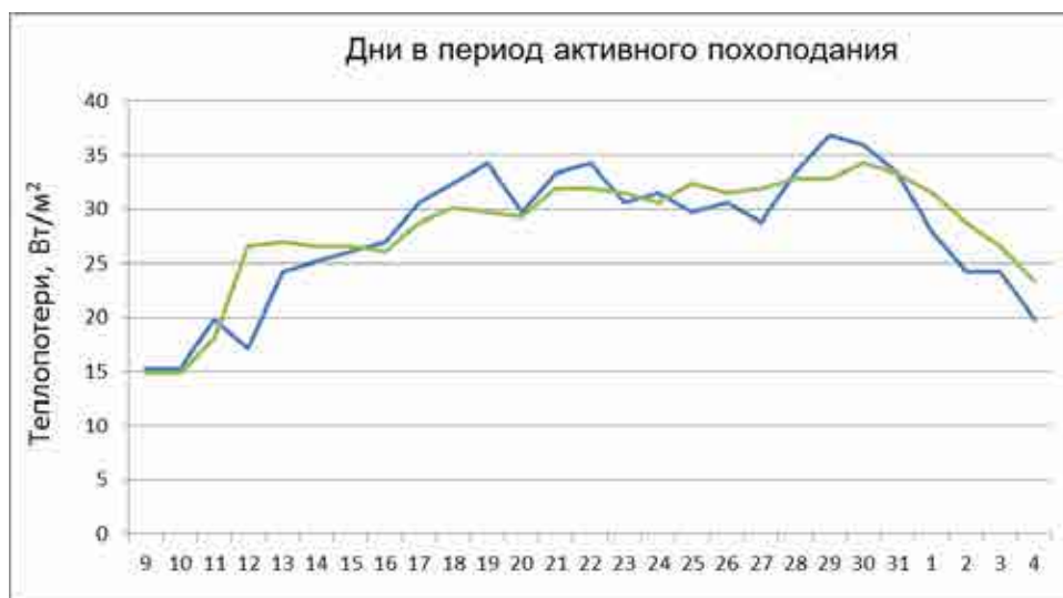
Рис. 3. Изменение потерь тепла в период активного похолодания, Вт/м 2
