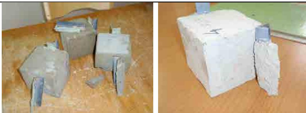
Рис.3. Характер разрушения клеевого соединения после испытаний на сдвиг
