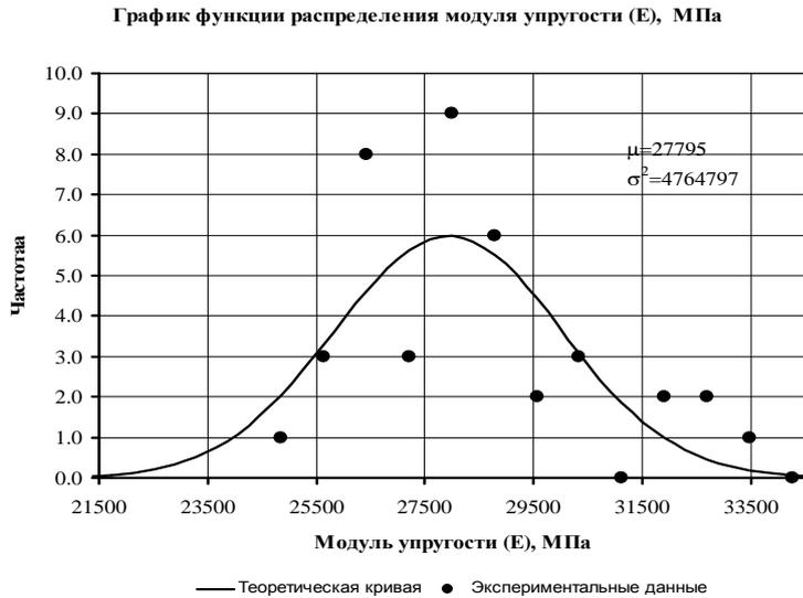
Рис. 1. Графики распределения деформативно-прочностных показателей базальтоволоконистых композитов (окончание)
