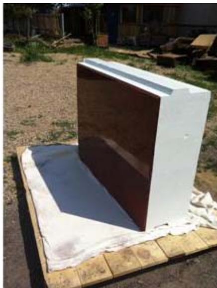
Рис. 2. Фасадная часть стеновых крупноформатных блоков из цветного архитектурного высокопрочного реакционно-порошкового фибробетона с бесцветным прозрачным защитным покрытием
