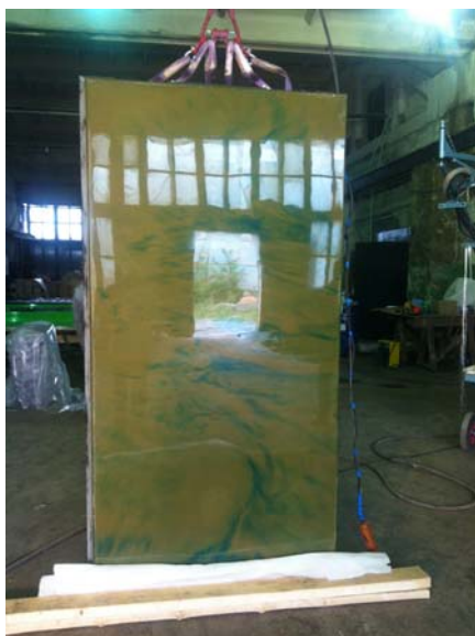
Рис. 2. Фасадная часть стеновых крупноформатных блоков из цветного архитектурного высокопрочного реакционно-порошкового фибробетона с бесцветным прозрачным защитным покрытием
