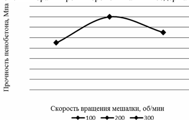
Рис. 2. Зависимость прочности пенобетона плотностью 500 кг/м 3 от скорости вращения вала смесителя при приготовлении пеномассы
