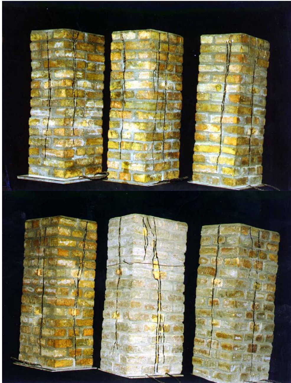
Рис. 4. Характерные схемы разрушения кирпичных призм
