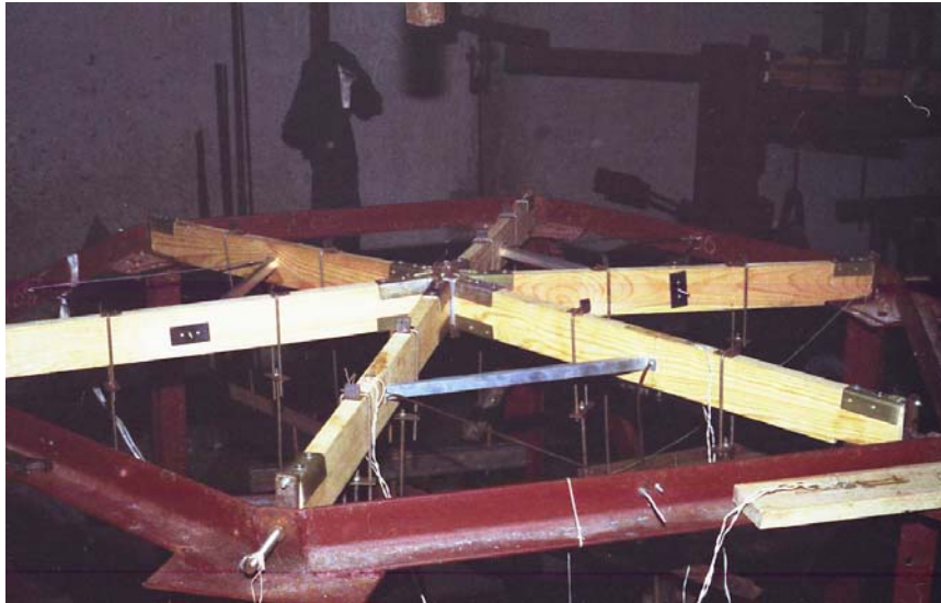
Рис. 1. Общий вид фрагмента стержневого купола на испытательном стенде
