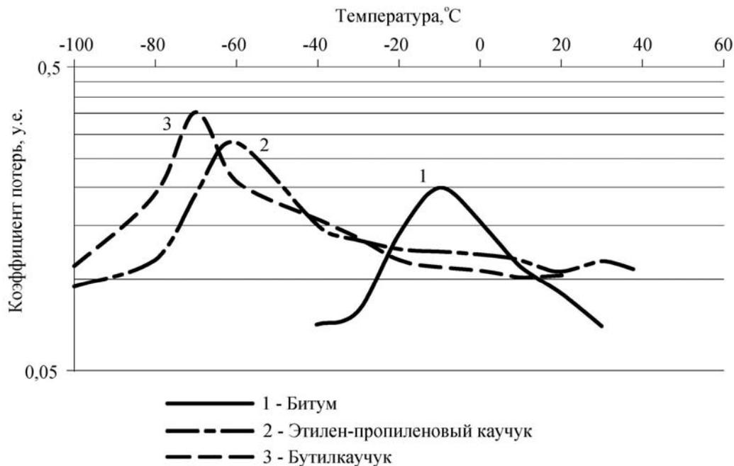
Рис. 3. Температурная зависимость приведенного коэффициента потерь синтетических каучуков и битума
