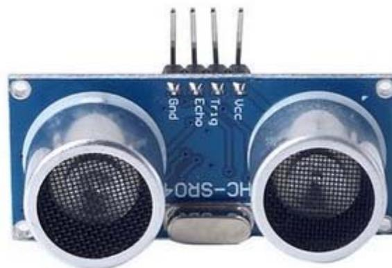
Рис. 1. Внешний вид датчика измерения расстояния HC-SR04
