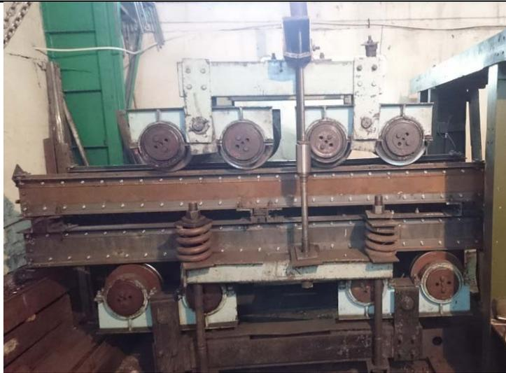
Рис. 3. Стенд для испытаний с балками СБ-1
