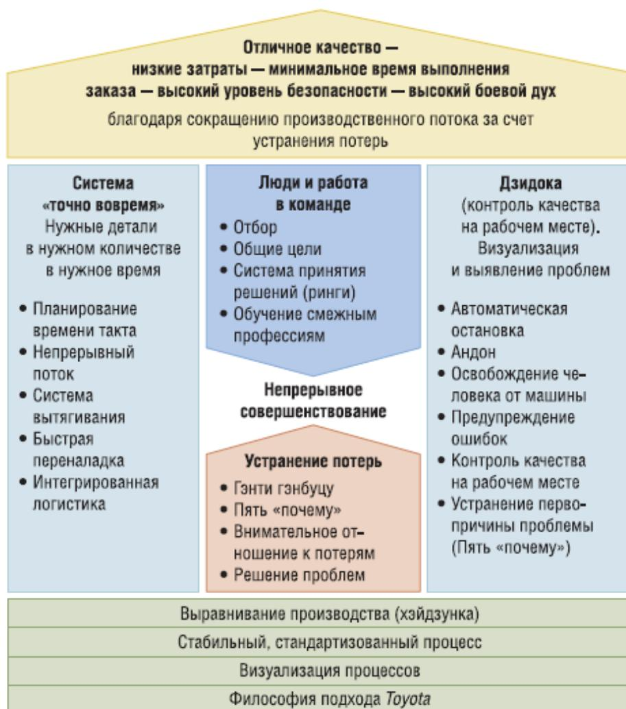
Рисунок 3. Производственная система «Тойота»
