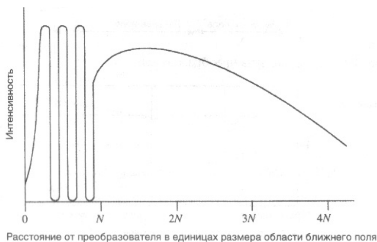
Рис. 4.4. Распределение интенсивности ультразвуковых волн в зависимости от расстояния от преобразователя
