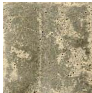
Рис. 6.19. Поверхность образца, приготовленного на основе воды в МС после циклического замораживания-оттаивания
