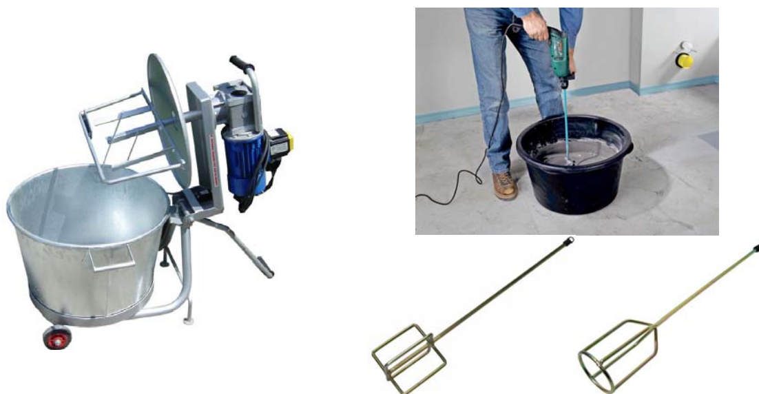
Рис. 13.1. Возможные базовые варианты перемешивающих устройств, которые можно использовать для магнито-механической активации
