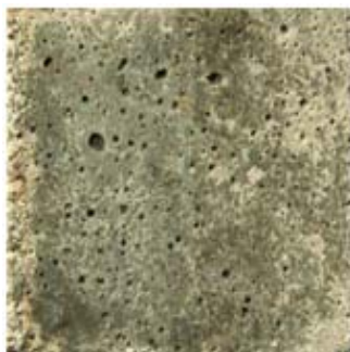
Рис. 6.18. Поверхность образца, приготовленного на основе водопроводной воды после циклического замораживания-оттаивания
