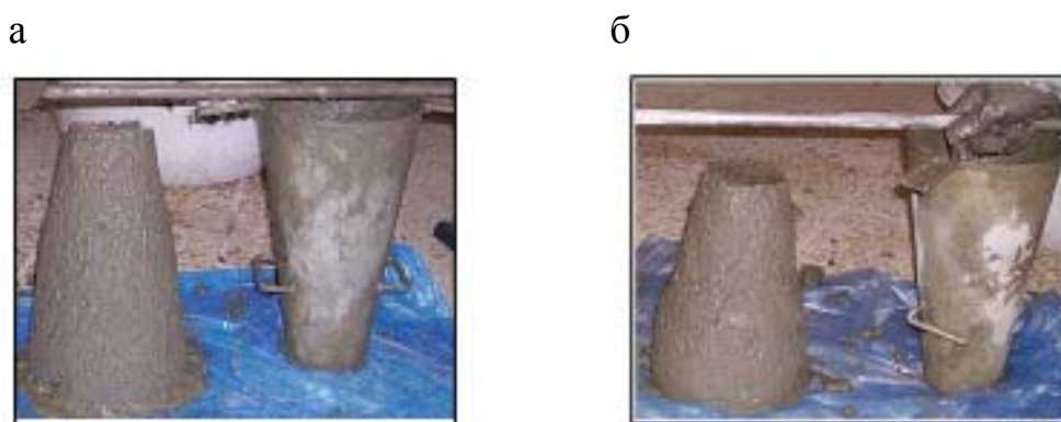
Рис.3.3. Изменение подвижности бетона: а – бетон приготовленный с использованием обычной воды; б – бетон, на омагниченной воде
