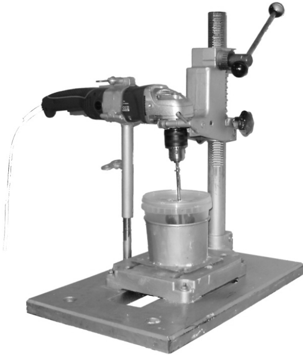
Рис. 7.3. Лабораторный аппарат, предназначенный для воздействия на воду затверения и растворные смеси в лабораторных условиях при приготовлении образцов для испытаний
