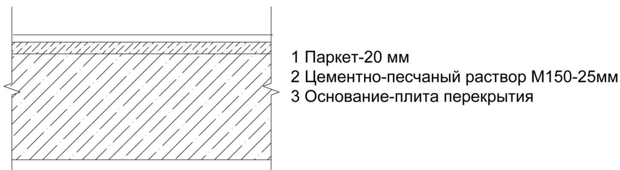
Рис. 54. Строительный пирог для устройства паркетного пола.
