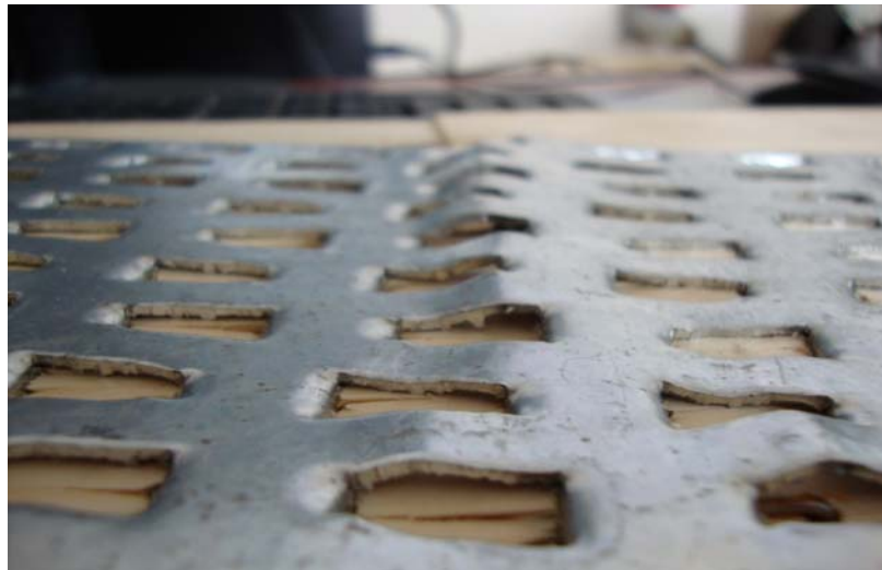
Рис. 7. Потеря устойчивости перегородок между зубцами и раскалывание древесины досок
