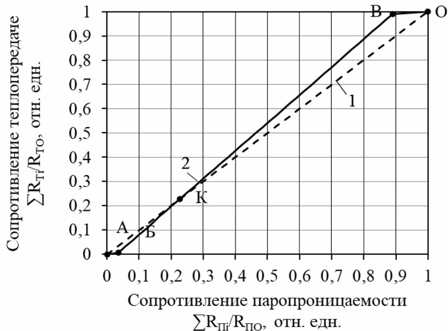
Рис. 2. Соотношение между сопротивлением теплопередаче и сопротивлением паропрооницанию:
