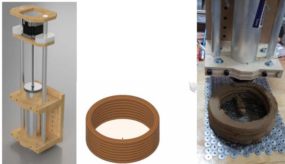
Рис. 5. Цифровые модели поршневого экструдера и объекта печати, выполненные в Autodesk Fusion 360, и их материализованные копии
