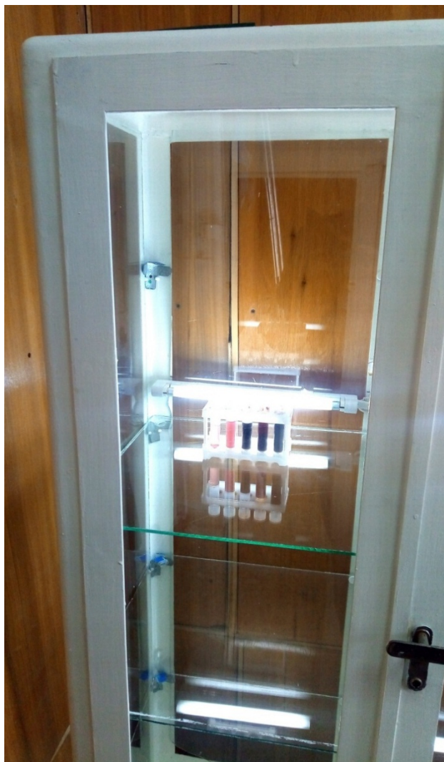
Рис. 3. Общий вид люминостата с пробами исследуемых щелочных растворов феррата натрия
