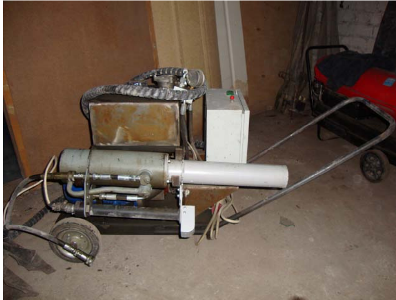
Рис. 1. Установка для натяжения канатов
