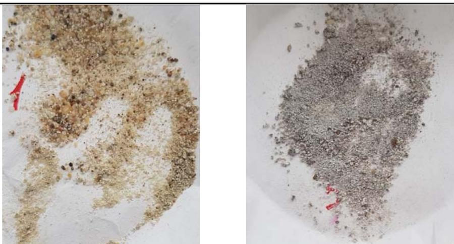
Остаток проб строительных растворов после отмытки: кварцевый песок с примесью глины (слева); кварцевый песок и гипс (справа)
