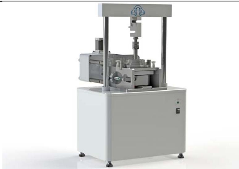
Рис. 1. Прибор одноплоскостного среза со статическим нагружением конструкции
