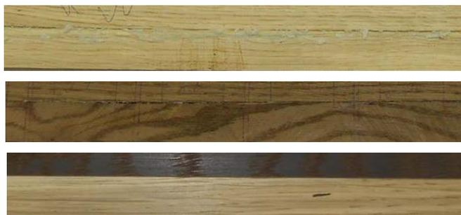
Рис. 4. Заготовки дуба для испытаний
