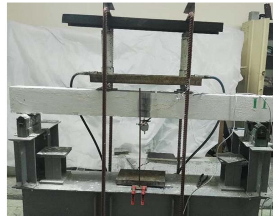
Рис. 4. Балка №1, армированная неперфорированными ЛСТП в виде двутавра до испытаний
