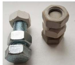
Рис. 4. Исходный объект и его реплика из высокофункционального бетона
