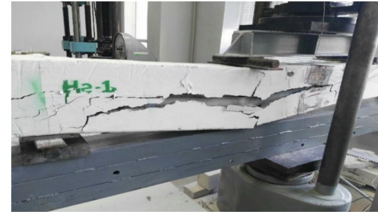
Рис. 6. Характерное разрушение всех трёх испытываемых балок, подтверждающее факт перерождения системы
