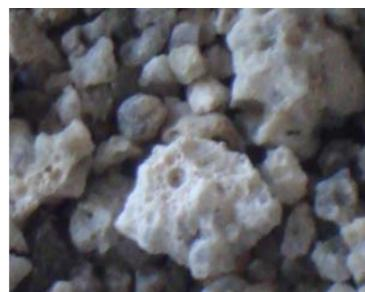
Рис. 2. Макроструктура доменного гранулированного шлака
