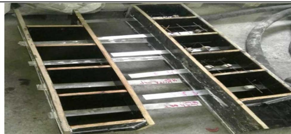
Рис. 1. Опалубка и установленные полосы для заливки опытных образцов
