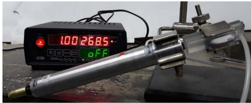
Рис. 3. Общий вид микроциклона, датчик кислородомера и кислородомер
