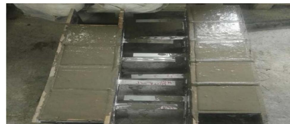
Рис. 2. Забивка ячеистым бетоном опалубки
