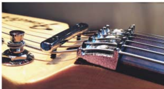
Рис. 2. Виды струнных прижимов (ритейнеров): а – сплошной ритейнер; б – парные ритейнеры
