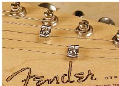
Рис. 2. Виды струнных прижимов (ритейнеров): а – сплошной ритейнер; б – парные ритейнеры
