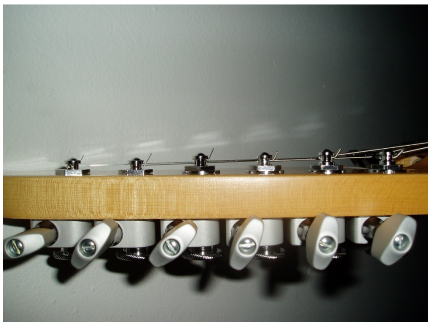
Рис. 3. Колки с переменной длиной штока (staggered shaft tuners)
