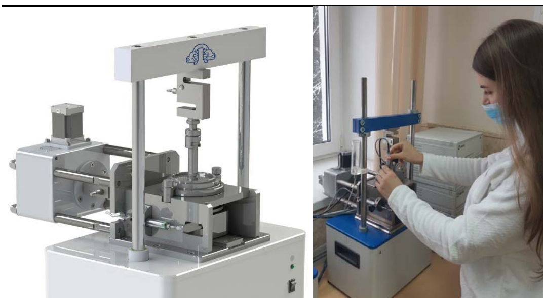
Рис. 1. Подготовка к испытанию на приборе одноплоскостного среза со статическим нагружением
