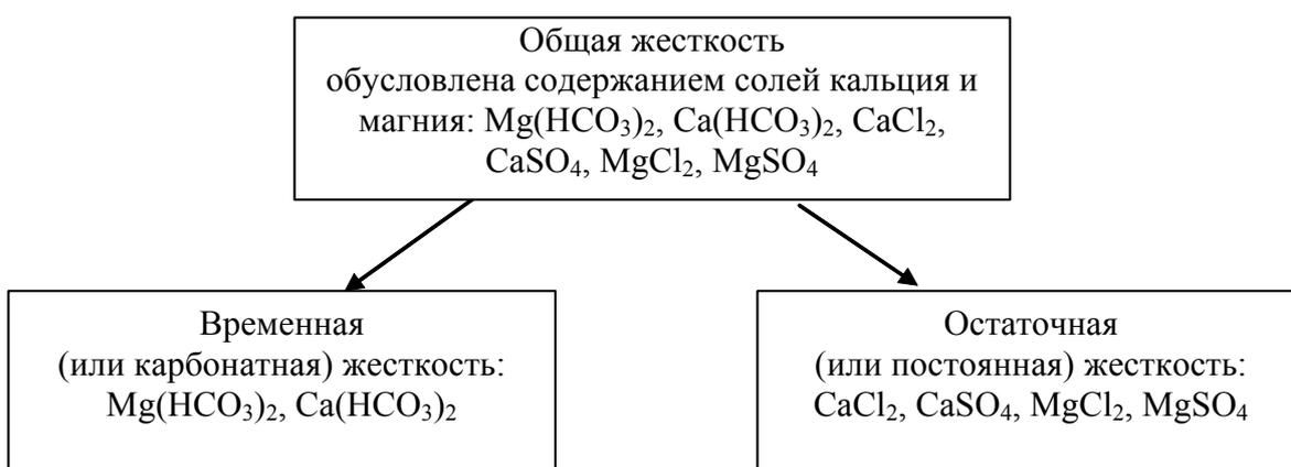
Рис.12. Схема жесткости воды
