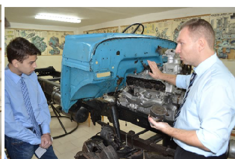
Доцент Р. Н. Москвин показывает работу реального ДВС на действующем стенде.
