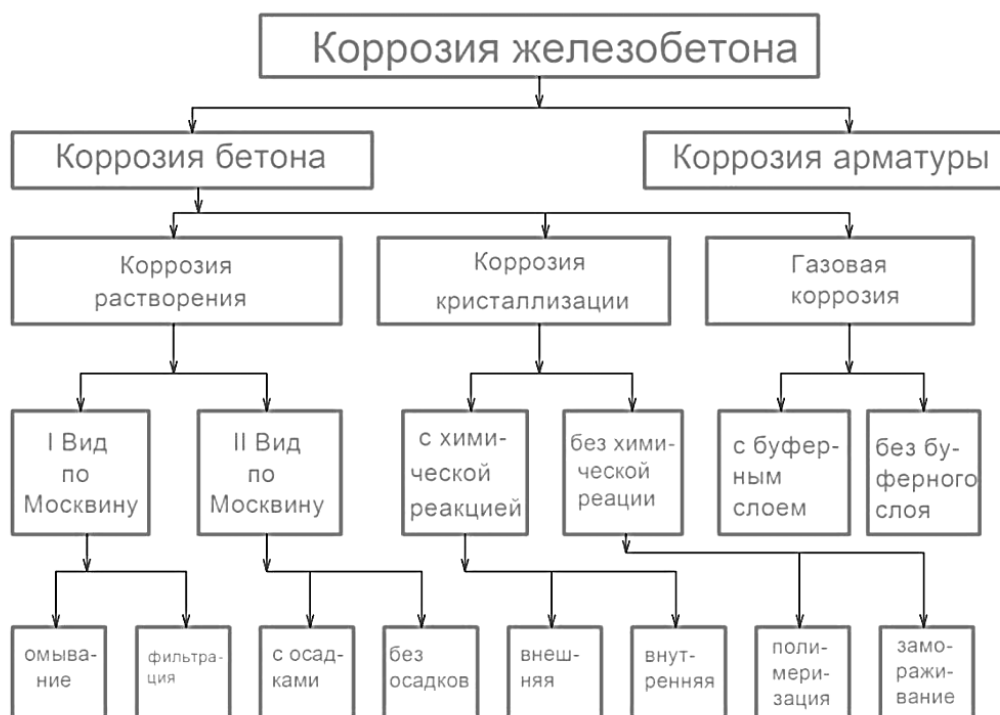
Рис. 1.6. Классификация коррозионных процессов в железобетоне
