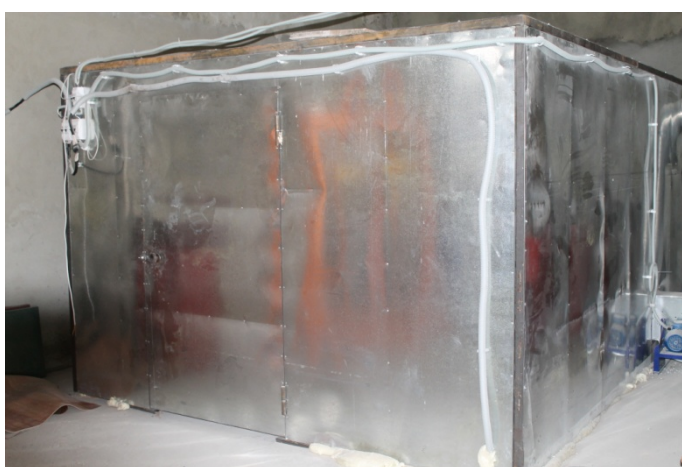
Рис. 5.4. Термокамера для изготовления резиновой гибкой черепицы
