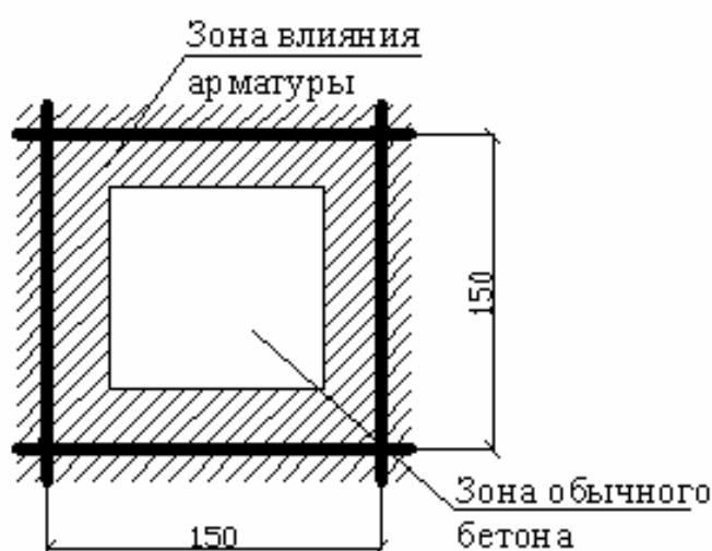
Рис. 4.10. Элементарная ячейка стяжки, армированной сеткой
