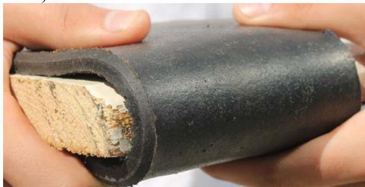
Рис. 3.20. Испытание образца на гибкость
