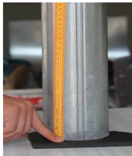
Рис.3.21. Схема испытания образцов кровельного материала на водонепроницаемость
