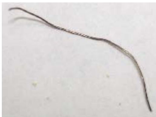
Рис. 4.7. Металлокord без дополнительной доочистки диаметром: а – 0,2 мм; б – 1,0 мм; в – 0,2 мм после доочистки
