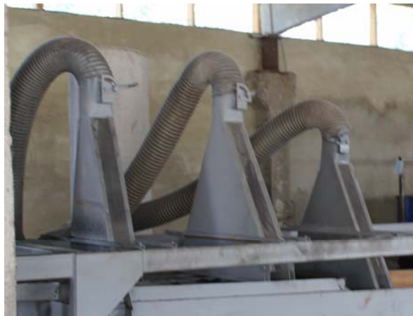
Рис. 2.3. Линия по переработке изношенных автомобильных шин КППШ-1: а – сита просеивателя; б – пылеуловитель с системой сит
