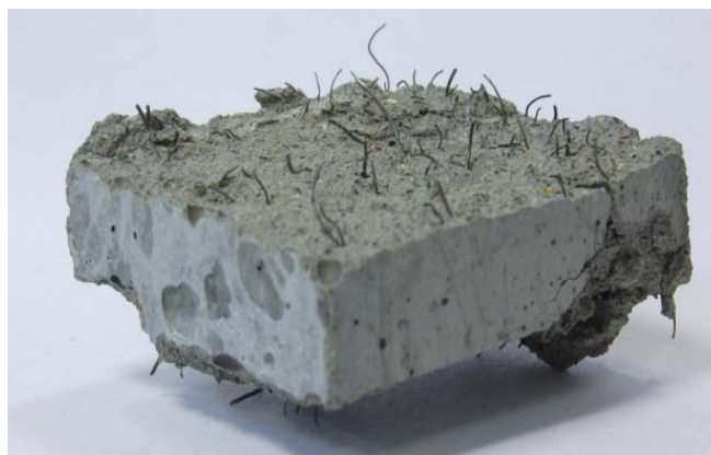
Рис. 4.12. Распределение металлокорда в теле порошкового бетона
