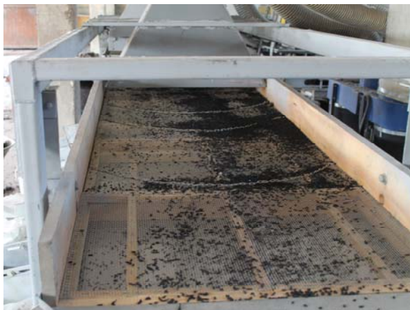
Рис. 2.3. Линия по переработке изношенных автомобильных шин КППШ-1: а – сита просеивателя; б – пылеуловитель с системой сит
