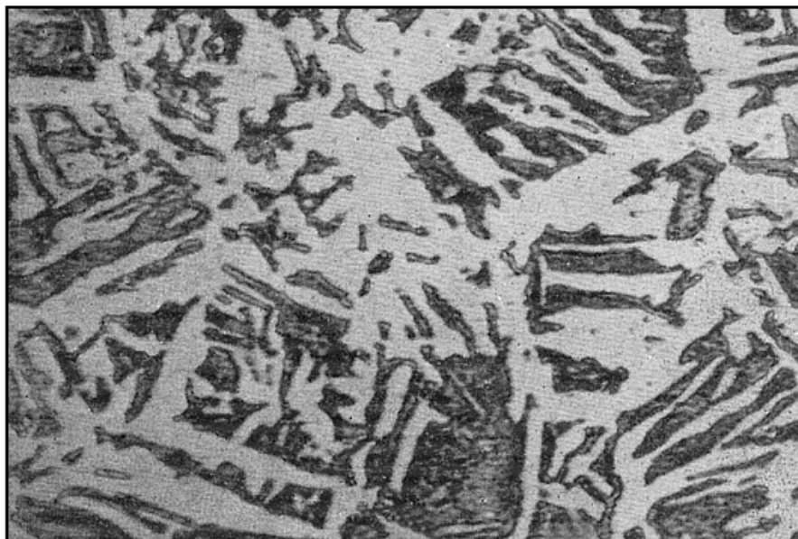
Рис. 35. Доэвтектоидная сталь (видманштеттова структура)
