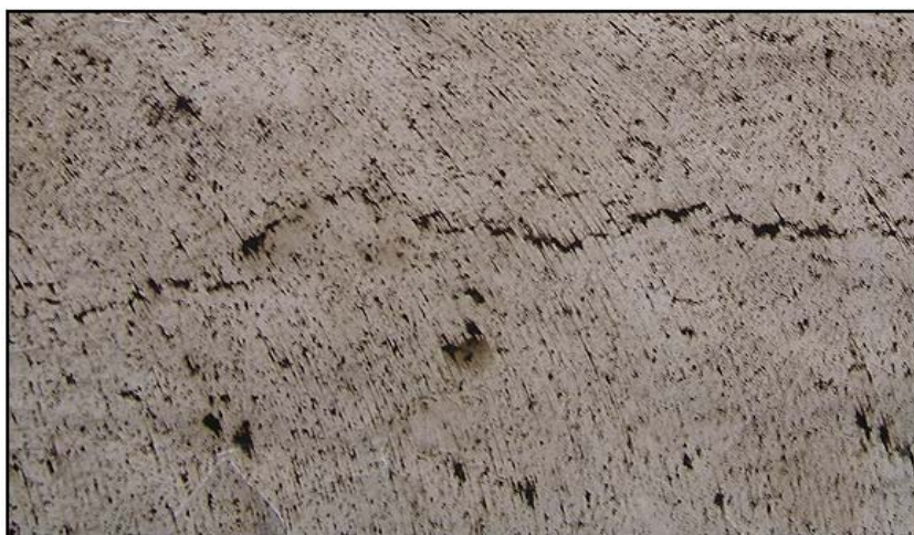
Рис. 3. Серный отпечаток, полученный с поверхности станины сверхмощного станка
