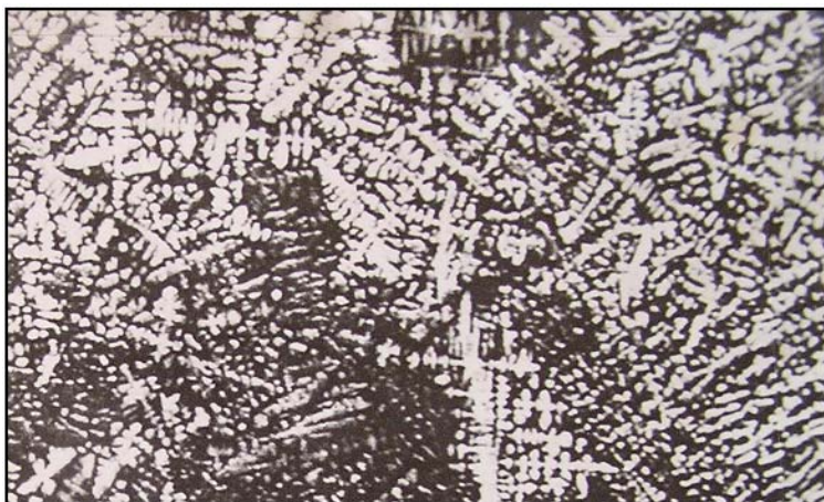
Рис.1. Макроструктура металла после глубокого травления (дендритное строение)
