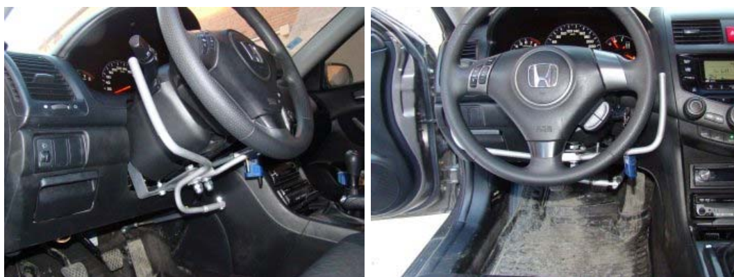
Рис.4.10. Honda Accord. Установлено РУ-РДС «Газ-Тормоз»
