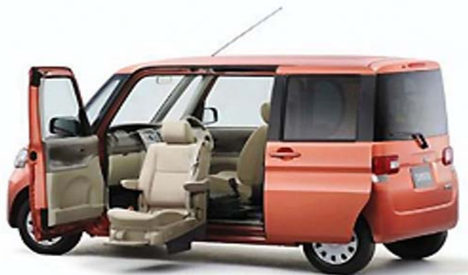
Рис. 4.29. Автомобиль Daihats Tanto Welcome Seat для людей с ограниченными возможностями
