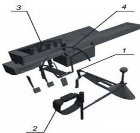
Рис.4.6. Устройство управления автомобилем инвалидам с нарушением функций одной из верхних конечностей
