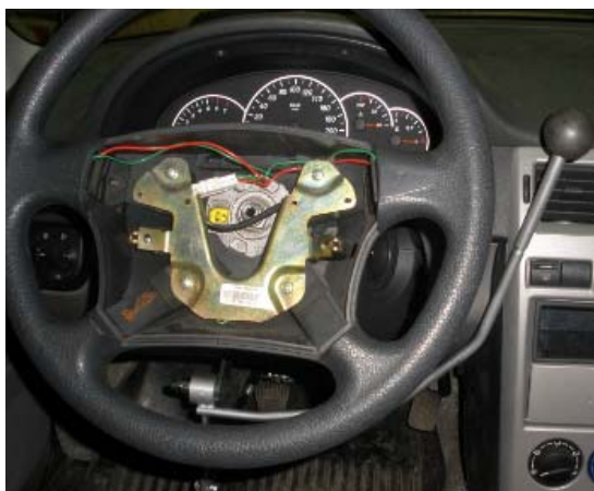
Рис.4.12. LadaPriora. Установлено РУ-РДС «Сцепление»
