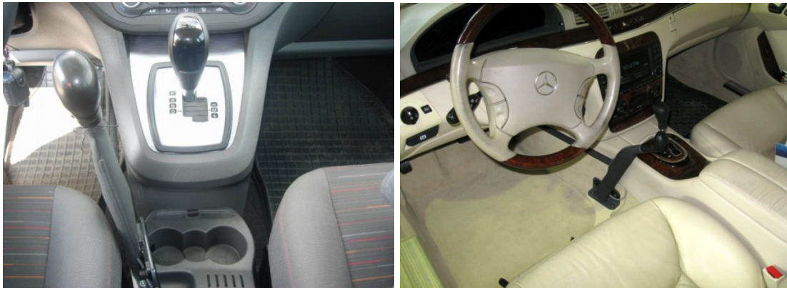
Рис. 4.16. Устройство управления автомобилем Carospeed
