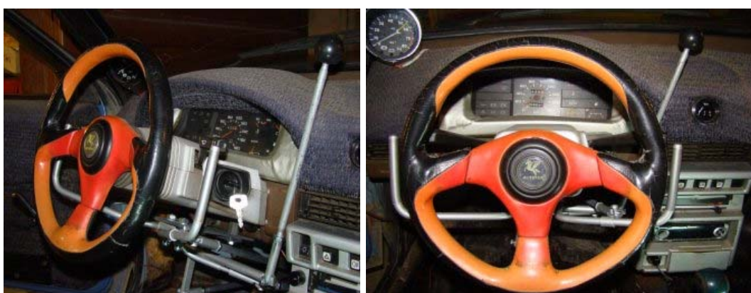
Рис. 4.13. ВАЗ-2108. Установлено РУ-РДС «Газ-Тормоз», «Сцепление»
