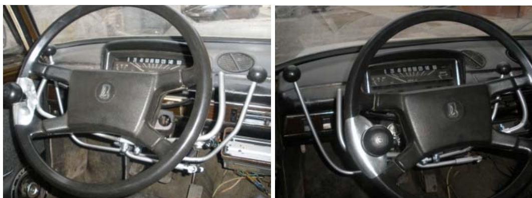
Рис. 4.14. ВАЗ-2101. Установлено РУ-РДС «Газ-Тормоз», «Сцепление»
