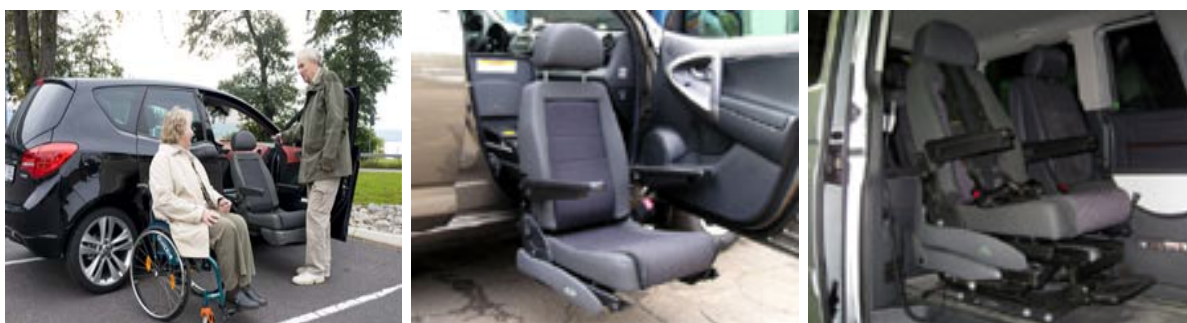
Рис. 4.23. Поворотно-выдвижной механизм TURNY EVO
