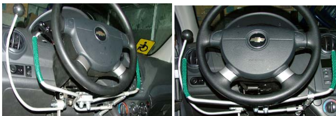
Рис. 4.11. Chevrolet Aveo. Установлено РУ-РДС «Газ-Тормоз», «Сцепление»
