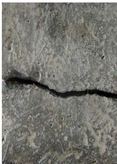
Рис. 5.12. Характер трещинообразования фибробетона: а – при использовании металлических волокон длиной 5 мм; б – при использовании металлических волокон длиной 15 мм
