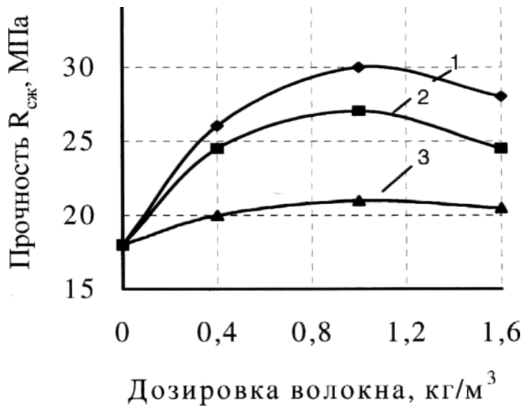
Рис. 5.2. Суточная прочность фибробетона в зависимости от содержания и длины используемого волокна: 1 – длина волокна 6 мм; 2 – то же 12 мм; 3 – то же 18 мм
