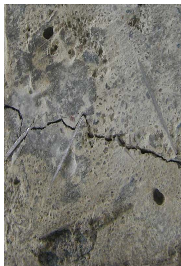
Рис. 5.12. Характер трещинообразования фибробетона: а – при использовании металлических волокон длиной 5 мм; б – при использовании металлических волокон длиной 15 мм
