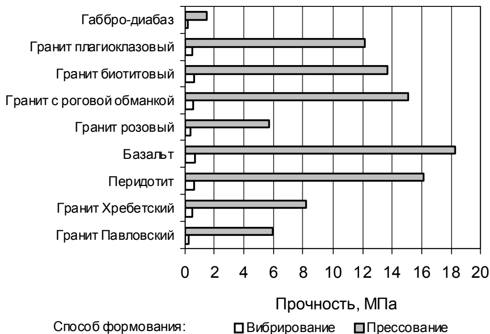
Рис. 4.4. Прочность вяжущих в зависимости от способа формования при твердении в нормальных условиях в течение 28 суток
