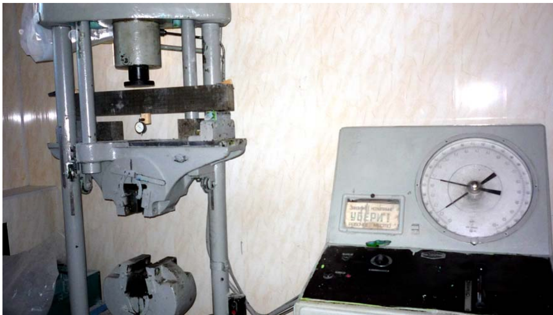
Рис.5.11. Испытание балки на испытательной машине УММ-50
