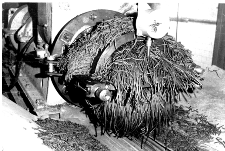
Рис. 3.10. Гранулирующая приставка к ленточному прессу
