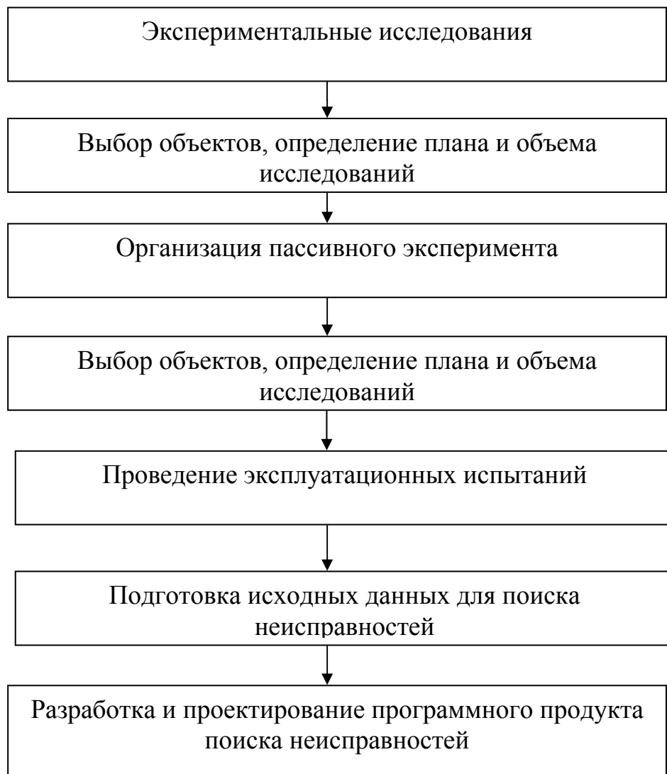
Рисунок 3.1 – Структурная схема методики экспериментальных исследований
