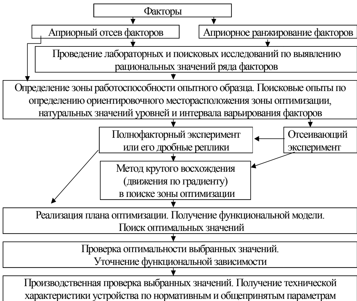
Рис.2.18. Общая схема проведения эксперимента при факторном планировании
